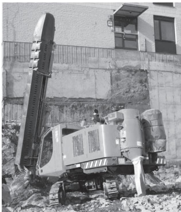
写真—6 ノイズガード・マフラーシステム
