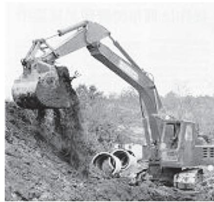
図-4 初代の20tクラス油圧ショベル
