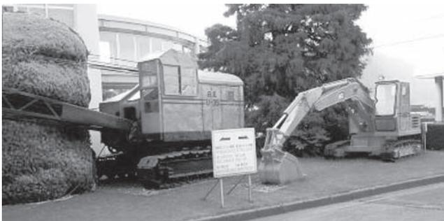
図-3 機械式(左)及び油圧(右)ショベル1号機
