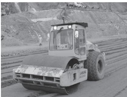
写真一5 GPS 搭載振動ローラー
