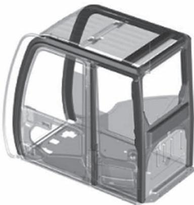
図一15 ROPS 対応キャブ構造
