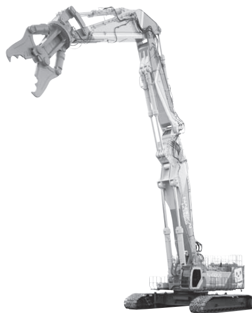
写真—2 SK3500D セパレート解体仕様機
