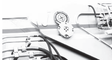
写真一 4 伸長時の油圧駆動式ピン
