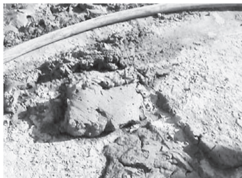
写真—5 粘土状になった汚泥
