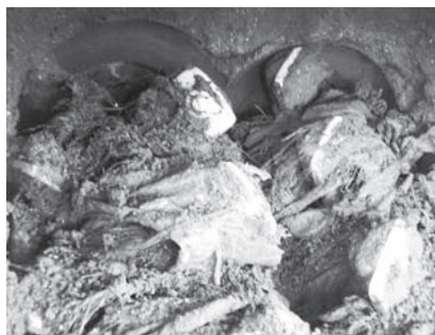
写真—4 改良機の攪拌翼に絡まった夾雑物
