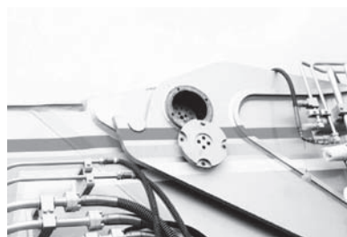
写真一 3 縮小時の油圧駆動式ピン
