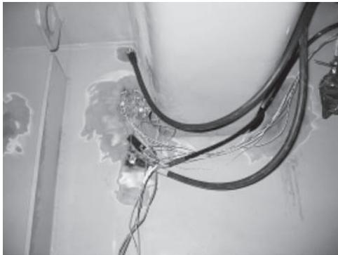
図一七 スカラップき裂発生部計測状況
