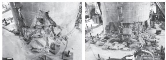
a) 1回目加振後                      b) 2回目加振後
