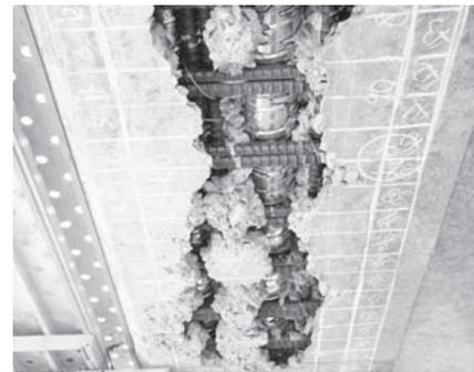
写真一2 試験体下面の空洞
