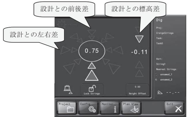
図—2 断面情報の提供画面（Leica Digger 3D）
