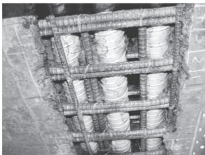
写真-4 はつり後の試験体下面
