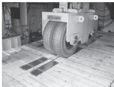
写真—1 移動荷重疲労試験状況
