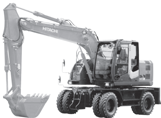
写真—1 日立建機 ZX145W-3 油圧ショベル（ホイール式）
