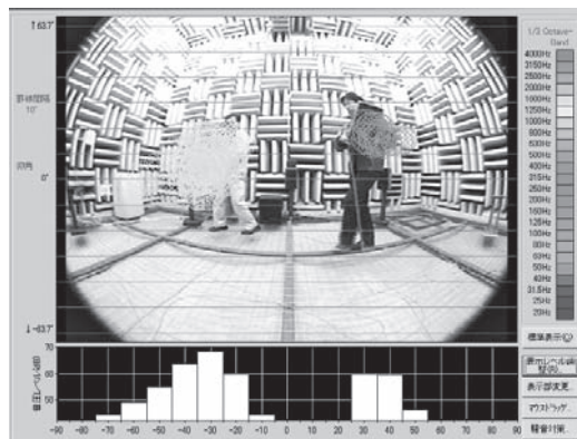
図—13 音源探査装置による音源位置の特定状況
