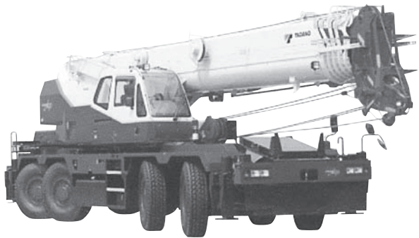
写真—5 タダノ GR-600N (Ⅱ) ラフテレーンクレーン
