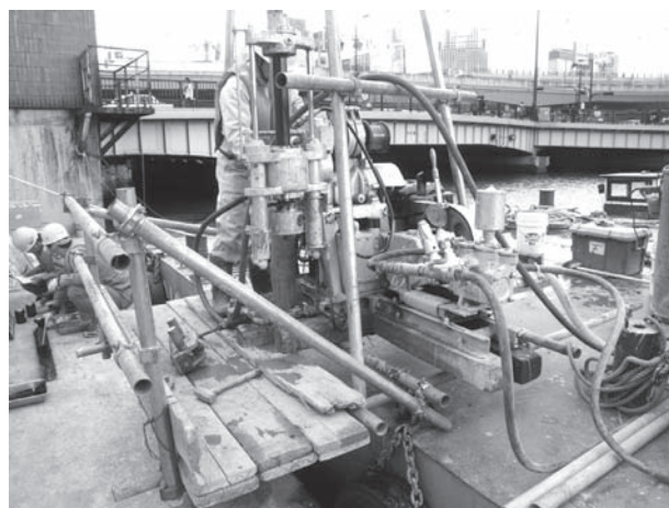
写真一4 ボーリングマシンによる試料の採取状況 写真左側が旧護岸、ボーリングマシンは作業台船に乗せている。
