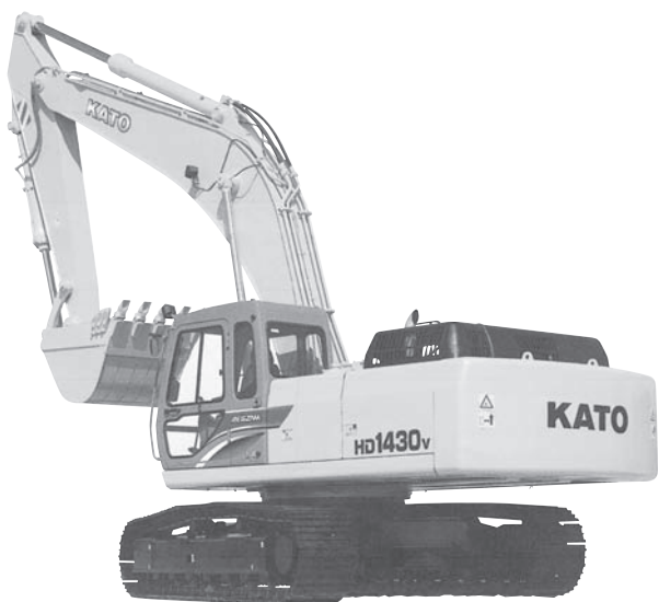
写真一 2 加藤製作所「REGZAM」HD1430V 油圧ショベル
