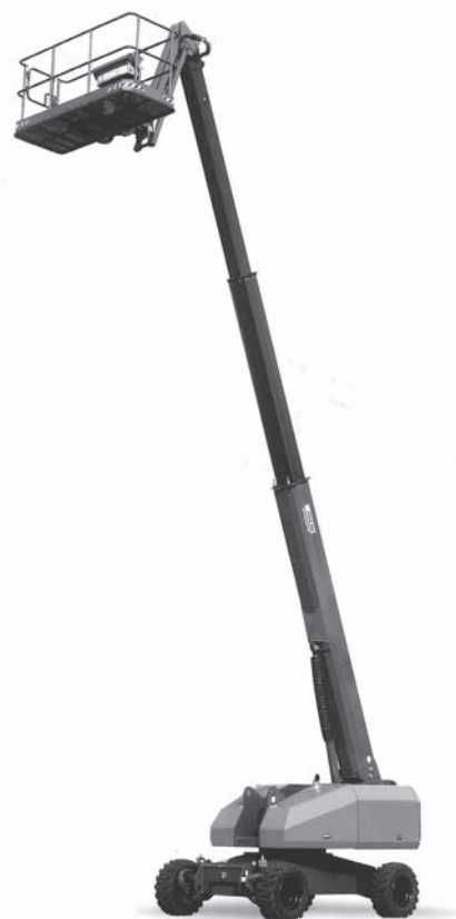
写真ー6 アイチコーポレーション「スカイマスター」SP14C 自走式 高所作業車
