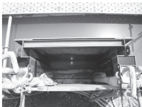
写真—1 大型水槽実験による止水性確認
