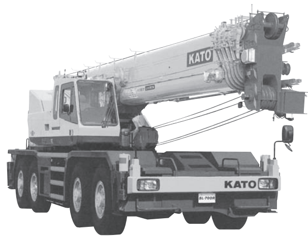
写真—4 加藤製作所 SL-700R PREMIUM ラフテレーンクレーン
