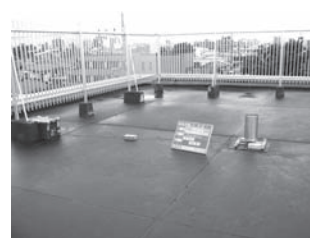
写真-2 転倒ます型雨量計(左)と設置状況(右)
