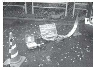
図-6 写真-1 面速式流量計による計測装置の例 図の出典: 流出解析モデル利活用マニュアル(下水道新技術推進機構)
