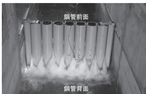
写真—2 実験状況（津波対象波）
