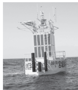
図—4 GPS 波浪計の例 （宮城県中部沖 平成19年3月設置）
