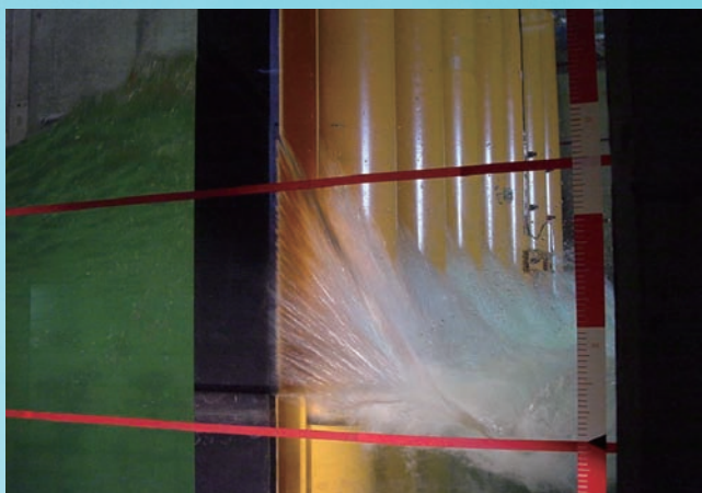
⇩水理模型実験（津波対象波・側面より）
