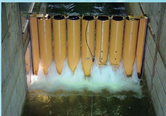
⇩水理模型実験（津波対象波・港内側より）
