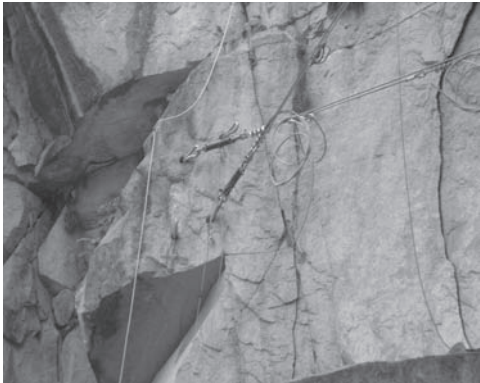
写真一2 ロードセル No.IX, X の取付状況
