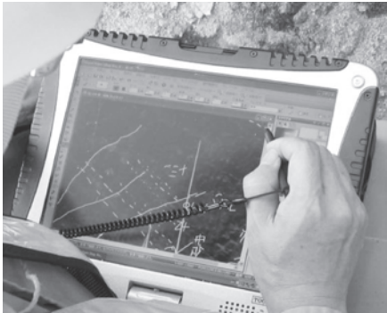
写真—1 岩盤スケッチ実施状況
