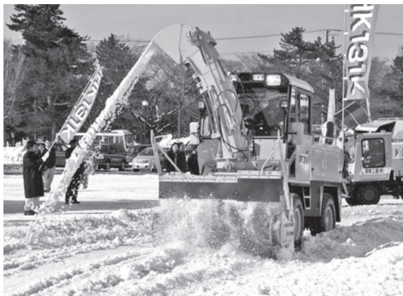
写真—9 ロータリ除雪車 1.65 m ～ 1.87 m 可変幅員型
