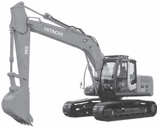
写真—1 日立建機 ZX180LCN-3 油圧ショベル（解体仕様）
