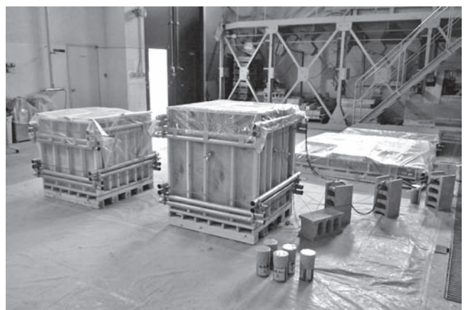
写真—4 IC タグを埋め込んだ大型コンクリート試験体
