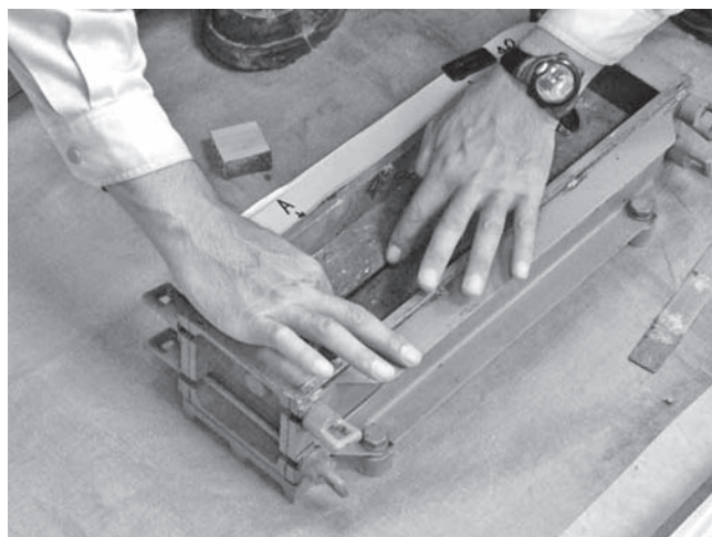
写真—3 小型コンクリート試験体に IC タグを埋め込んでいる様子
