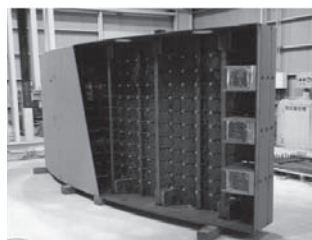
鋼殻の完成状況（背面 PL 撤去）
