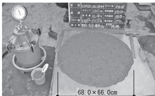
写真—1 高強度コンクリートのフレッシュ性状
