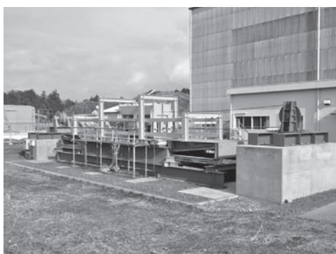
写真一 9 屋外輪荷重疲労試験機 &lt; 2 号機 &gt;
