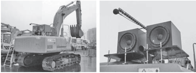
写真一 2次音源およびエラーマイク設置状況 (実験1)
