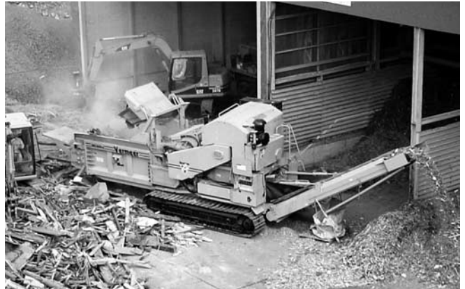
横投入式木質系粉碎処理機（ホリゾンタルグラインダー）
