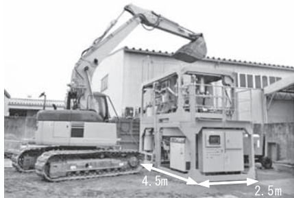
写真—2 流動化砂製造プラント
