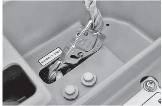
図一五 安全帯インターロック（安全帯を取付ける事で操作が可能になる）
