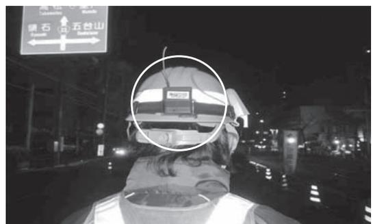
図— 3 受信器 (作業員側) 装着状況
