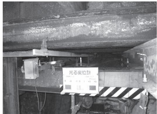
写真—4 光る変位計：計測箇所
