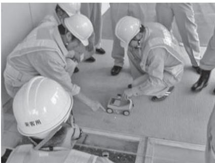
写真—11 埋設物探査
