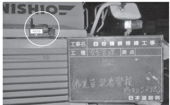
図— 2 発信器 (重機側) 設置状況
