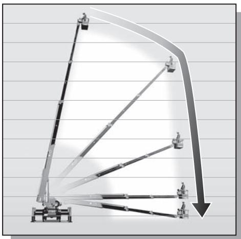
図-11 ノンストップ規制装置の作動イメージ
