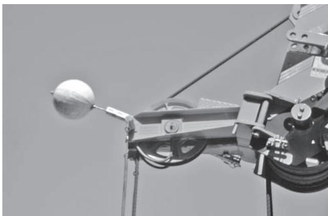
写真一3 クレーンへの球面リフレクタ取付け例
