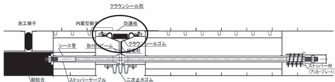
図一 10 クラウンシール継手の構造
