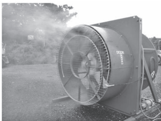
冷却能力 180 kW 風量 2,100 m 3 /min
