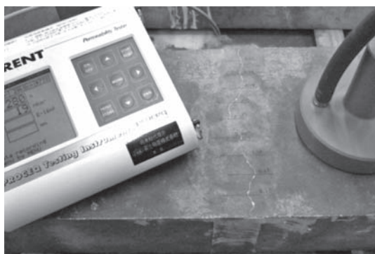
写真—6 表面透気試験状況
