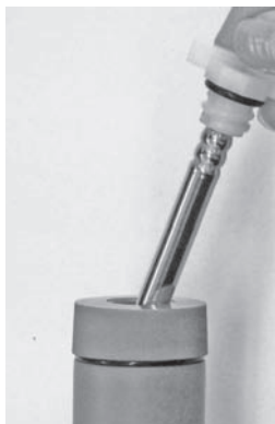
写真－4 イニシエーター装填
