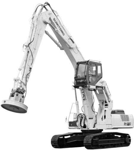
写真一 2 住友建機 SH350HD-5LCWMH 油圧ショベル (マグネット／グラップル仕様)
