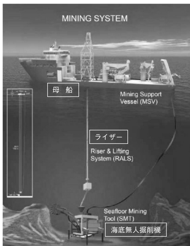
図-7 Technip 社が提案する海底熱水鉱床の生産概念図：海底に掘削機を降ろし、掘り碎いた鉱石を海上の母船まで吸い上げる。日本でも同様の方法と考えられる。
