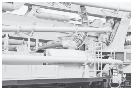
写真－2 電動モーター駆動油圧ユニット
