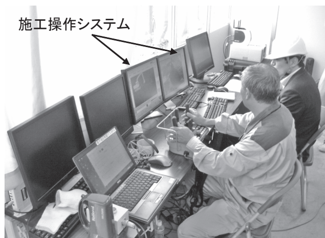
写真一 2 施工操作システム
