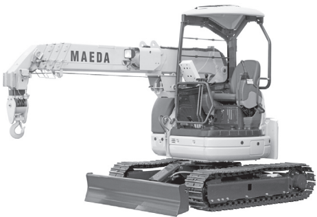
写真ー3 (株)前田製作所 LC383M-5 クローラクレーン 走行姿勢
