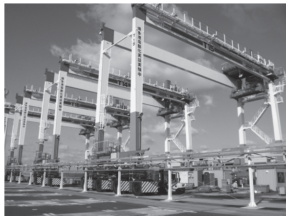
写真-6 トランスファークレーンの電動化
