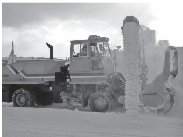
写真一五 大型ロータリー除雪車の迫力ある除雪作業
