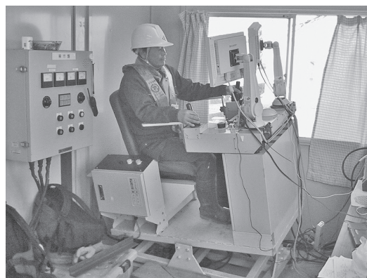
写真-4 遠隔操縦状況（体感装置）
