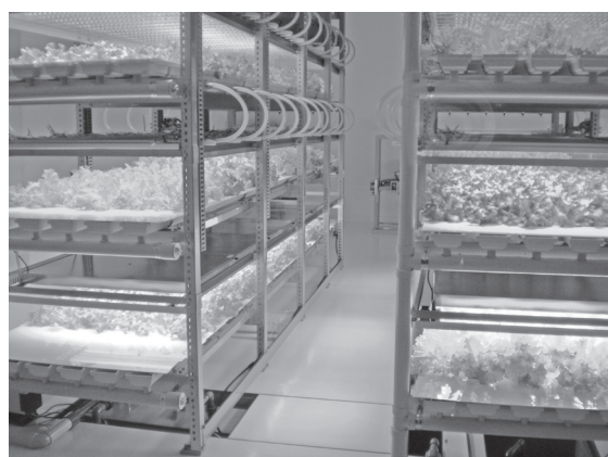
写真—6 各色LED照射による育成試験 (玉川大学)
