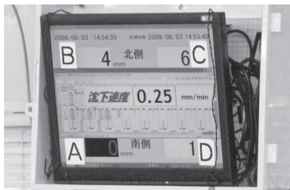
写真一5 躯体の傾斜表示モニター
