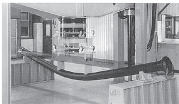
写真一 1 管体曲げ試験
