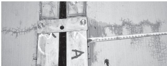
写真一 3 乾燥したコンクリート管の水リーク
