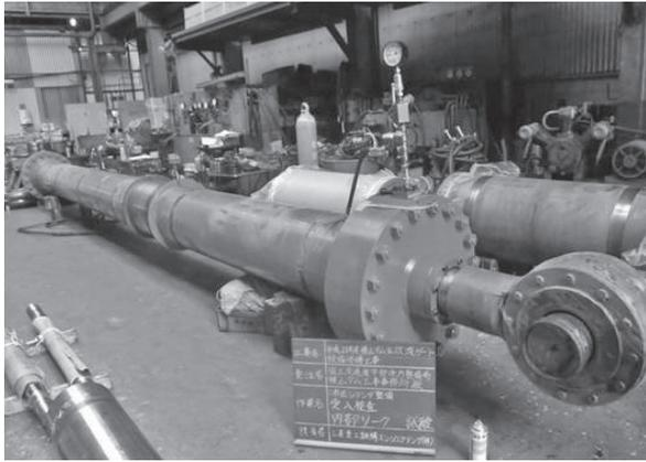
写真一六 性能試験状況（受け入れ時）
