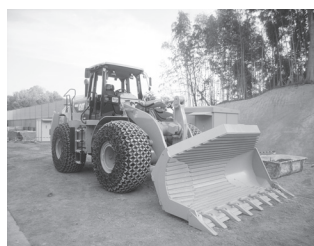
写真—3 サイドダンプローダ 3.0 m 3
