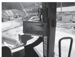
写真―10 後方確認用モニター
