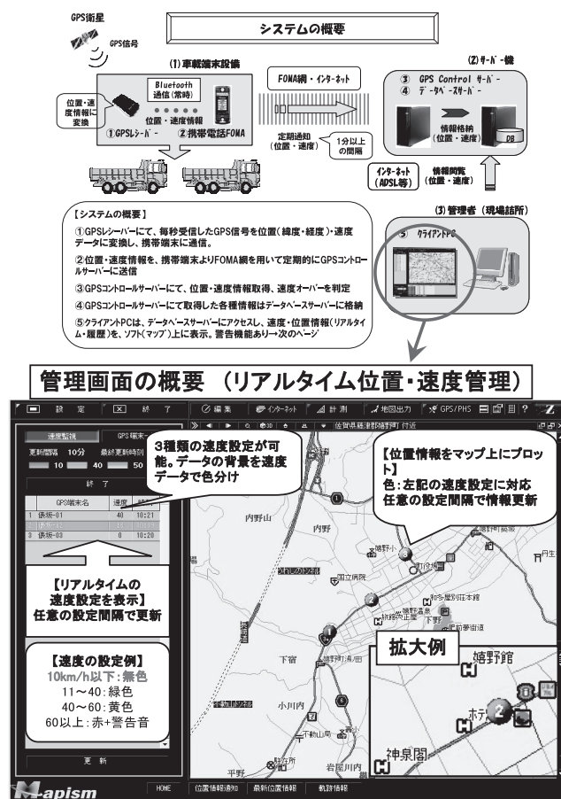
図-7 GPS車両位置管理システム
