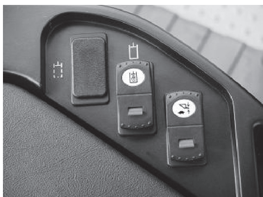
写真ー6 荷役装置ロックレバー（電気式）
