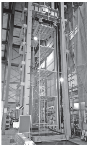
写真一 3 4層1スパン足場実大試験
