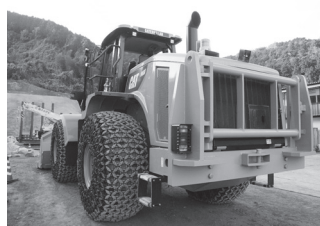
写真―9 後方確認カメラ
