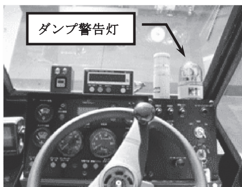
写真—9 ダンプ警告灯
