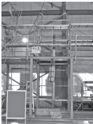
写真一 1 手すり枠落下阻止性能試験
