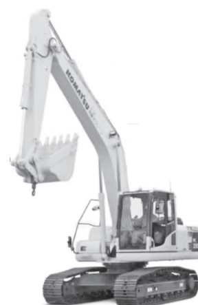
写真3 クレーン機能を備えたドラグ・ショベル
