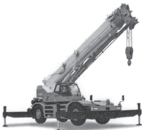
写真1 ラフテレーンクレーン
