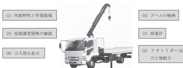
図-2 積載形トラッククレーンの安全管理ポイント
