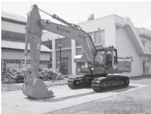
図一 1 空輸対応型油圧ショベル全景
