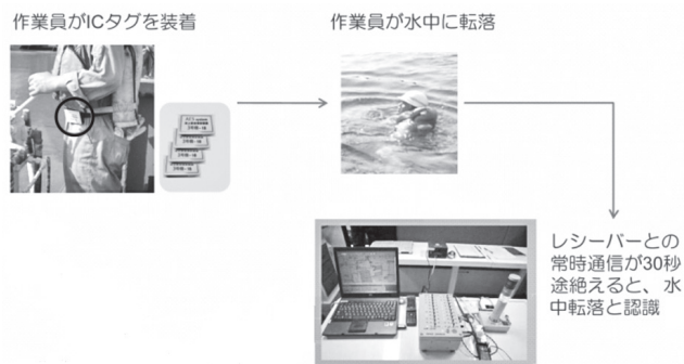
図－2 IC タグによる水中転落者早期検知システム
