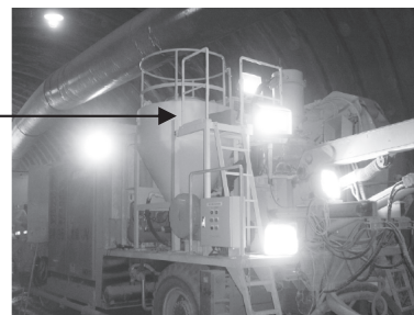
急結剤補給装置を一体架装した例
