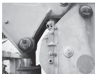
写真—19 ブーム格納忘れ防止装置
