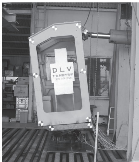
写真-4 ROPS 試験状況
