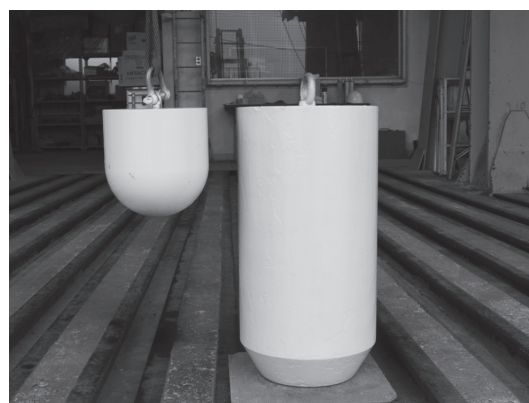
写真—1 打撃重錘 (左：レベルⅠ用、右：レベルⅡ用)
