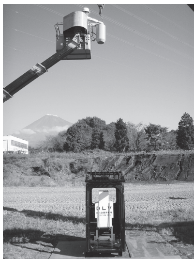
写真—3 トップガードの試験状況
