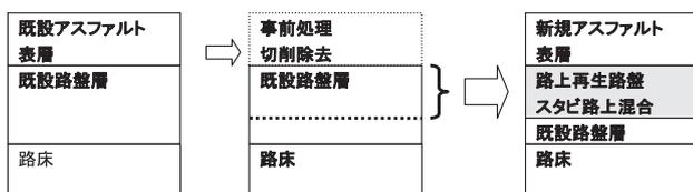
図—3 事前処理 (アスファルト混合物の撤去) を行って安定処理する方法の適用例
