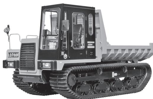
写真一 4 キャタピラー・ジャパン LD700F クローラキャリア（不整地運搬車）
