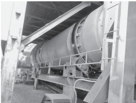
写真—3 回転数制御ドライヤ全景
