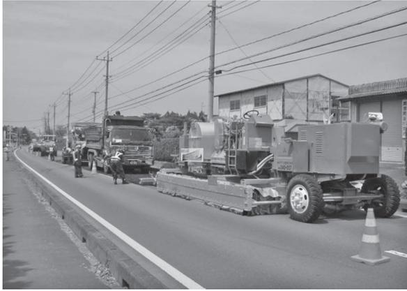
写真-5 路上表層再生機を用いた路面維持工法
