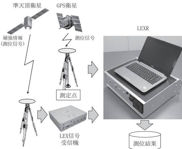
図-8 低速移動体端末 (LEXR)
