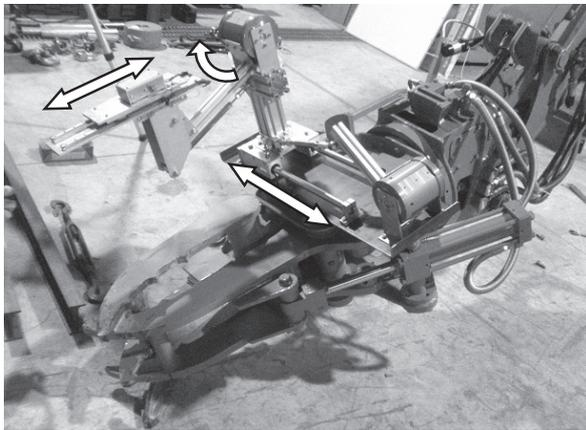
図一 13 電動補助アームの自由度
