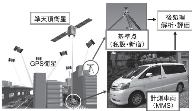
図一4 補完機能の評価システム
