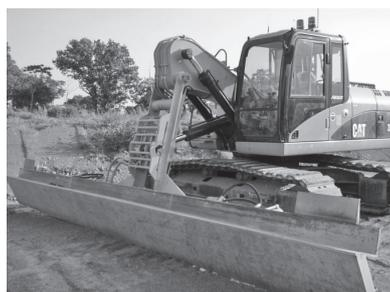
写真—4 型枠用ブレード
