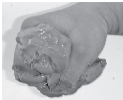
写真—2 ゲル化した余掘り充填材
