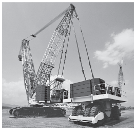
写真—1 6000SLX 外部カウンタウエイト仕様（タイヤ式）
