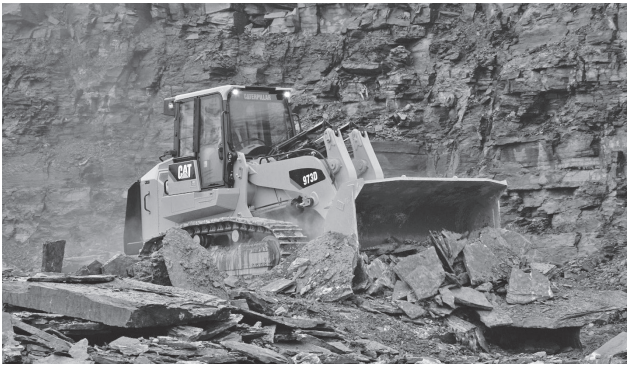
写真一 1 キャタピラージャパン Cat 973D 履帯式ローダ
