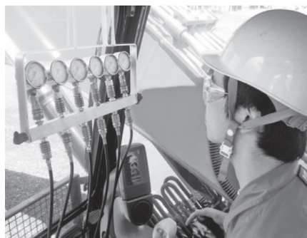
油圧機器の圧力計測
