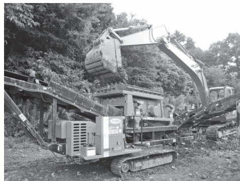
図—3 作業の外観（VR408（左）、右のパワーショベルはZAXIS200）
