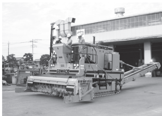
写真-1 地盤整正機全景
