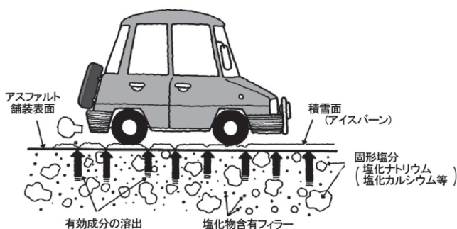
図—5 化学系凍結抑制舗装の原理 1)
