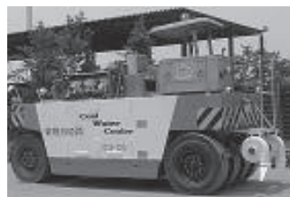
写真 6—48 鹿島道路(株) 冷却製造機構内蔵タイヤローラ
