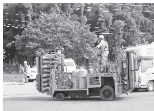
写真ー２ 移動・運搬時の小型路面ヒータ車 (LPG 赤外線パネルを折り畳んだ状態)
