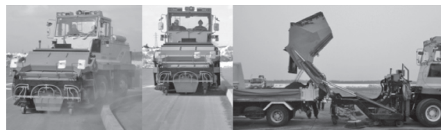
写真—2 テストコースでの性能試験状況 左：道路線形追従走行試験 中：清掃能力試験 右：ダンプトラックへの積み込み試験
