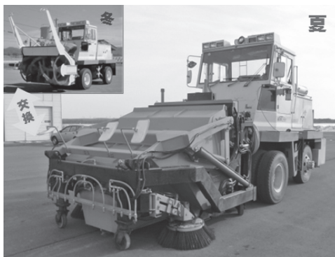
写真-23 アタッチメント式路面清掃装置
