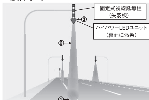
図2 ハイパワー LED を用いた視線誘導施設のイメージ
