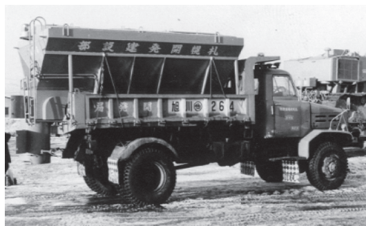
写真—15 凍結防止剤散布装置
