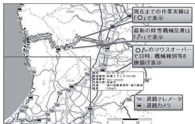
図-2 除雪作業状況確認システム表示画面
