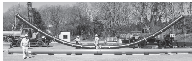
写真－3 高密度ポリエチレン管の継手要素試験
