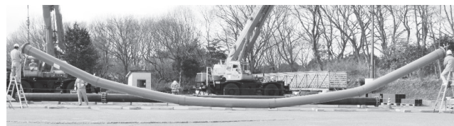
写真－5 硬質塩化ビニル管の継手要素試験
