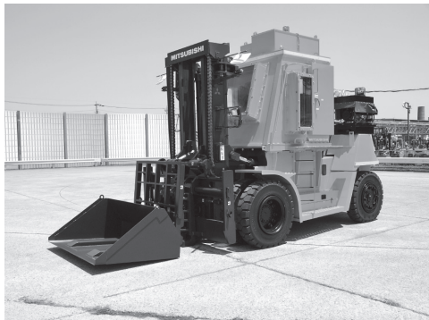
写真—2 放射線遮蔽キャビン付きフォークリフト2号車（バケット仕様）
