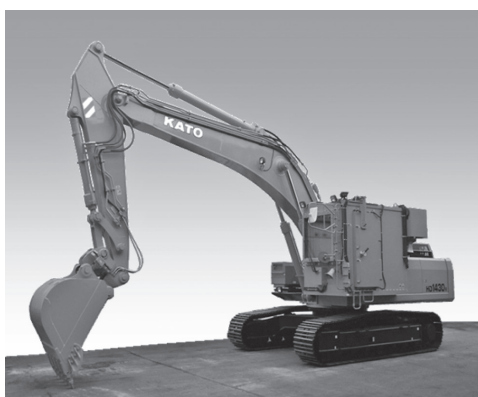
写真—9 放射線遮蔽キャビン付き油圧ショベル（30t級、バケット容量1.4 m 3 ）
