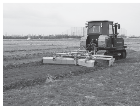
写真—10 放射線遮蔽キャビン付きトラクタによる土壌除染（表土の剥ぎ取り）
