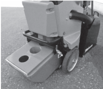
写真—4 ワンタッチ引き出し式大型 20ℓ ダストケース
