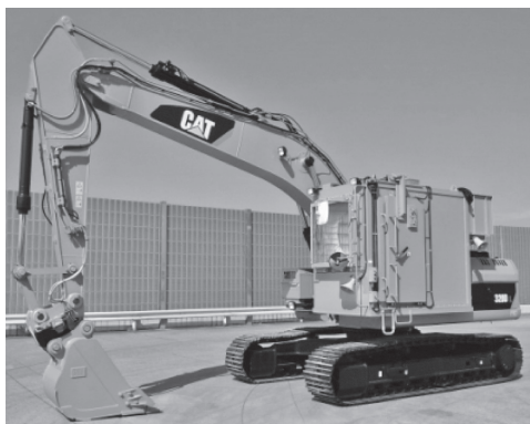
写真—8 放射線遮蔽キャビン付き油圧ショベル（20t級、バケット容量0.9 m 3 ）
