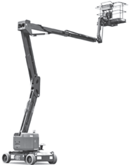
写真—8 アイチコーポレーション マックスリーチ WU14A 自走式高所作業車
