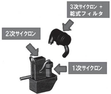
写真—6 3 ステージサイクロン集塵装置
