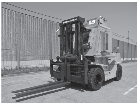
写真—1 放射線遮蔽キャビン付きフォークリフト1号車（フォーク仕様）
