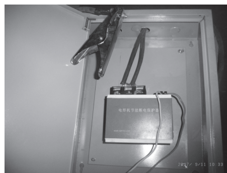
写真—6 交流アーク溶接機用自動電撃防止装置
