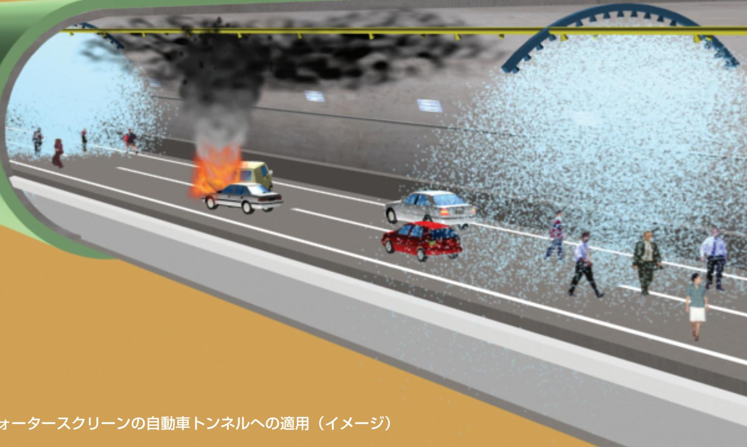
ウォータースクリーンの自動車トンネルへの適用(イメージ)
