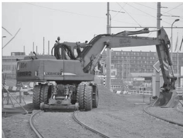
写真一一 デルフト駅前の工事現場で駐機中のタイヤ式油圧ショベル（軌陸車仕様）
