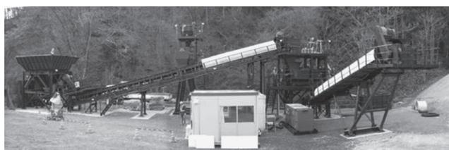
写真-4 CSGプラント(ユニット式)全景
