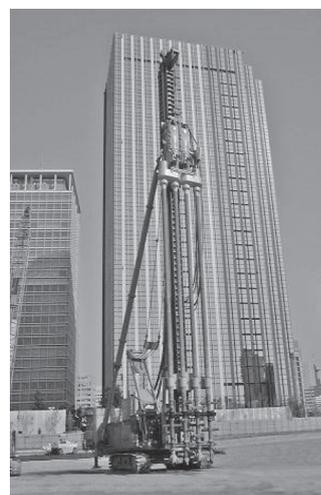
写真一 深層混合処理機（4軸機）
