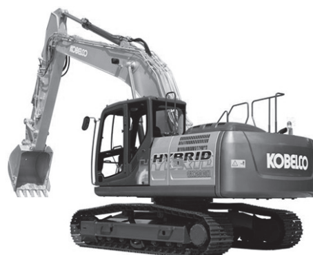
写真－3 コベルコ建機 SK200H ハイブリッドショベル
