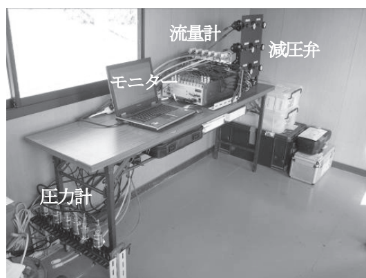
写真—1 空気注入システム
