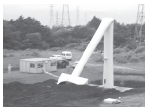
④風力発電タワー強度試験
