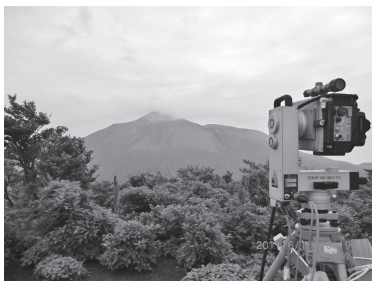
写真—5 地上レーザ計測の様子
