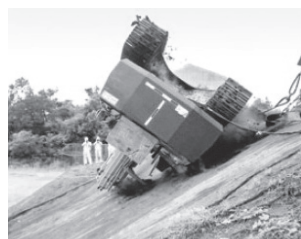
写真—11 油圧ショベルの転倒実験状況
