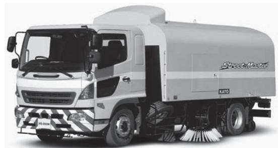
写真—4 加藤製作所 HS-800W 型 真空式路面清掃車
