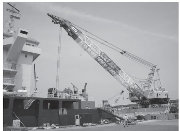
写真一6 全旋回式クレーン
