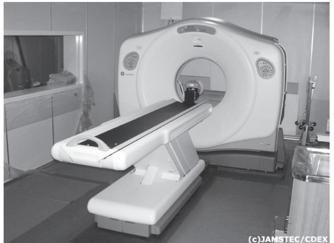
写真—3 「ちきゅう」研究室内に設置されているX線CTスキャナー。医療用に使われている物を応用し、掘削した試料の非破壊検査に用いている。
