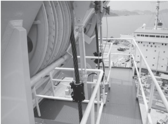
写真一八 ワイヤーロープ遠隔監視システム
