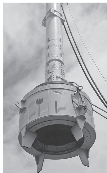
写真—3 低減装置付き油圧ハンマ (直江津)
