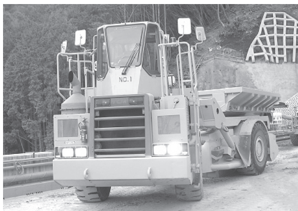
写真—3 ベッセル函運搬ダンプ
