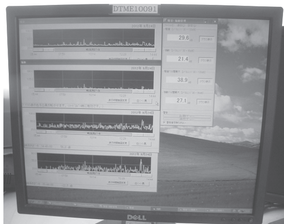
写真— 11 騒音・振動自動計測システム
