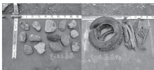
写真—7 吸引された石や異物
