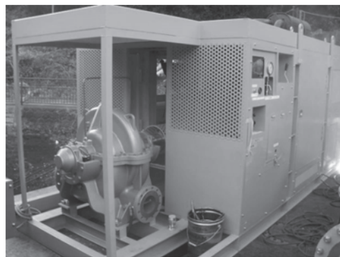
写真—4 超高圧ポンプ
