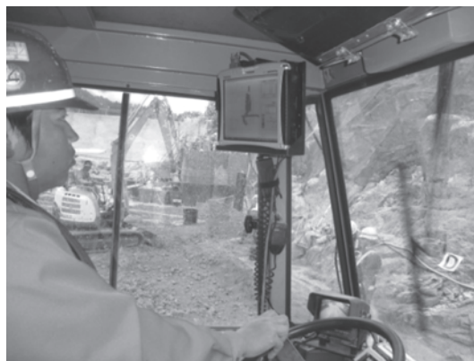
写真一 10 転圧管理システム
