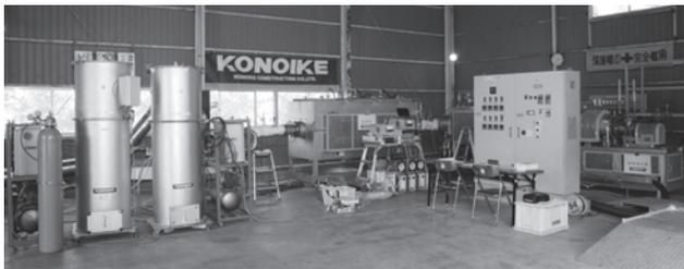
写真一 バイオマスガス化試験装置
