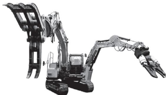
写真 1 日立建機 ZX135TF-3 [ASTACO NEO] 双腕作業機
