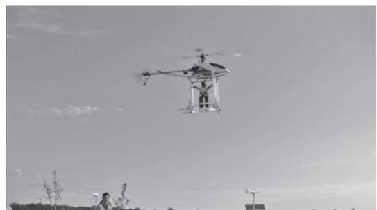
写真一14 二足歩行ロボット(CALI-BO)を空輸している無人飛行体(SARA-HV)
