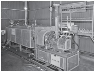
写真二 ガス化炉 (試料投入部)
