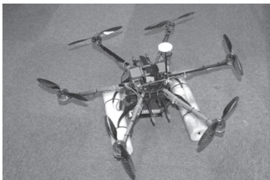
写真—16 多軸回転翼型無人飛行体 (SARA-X)
