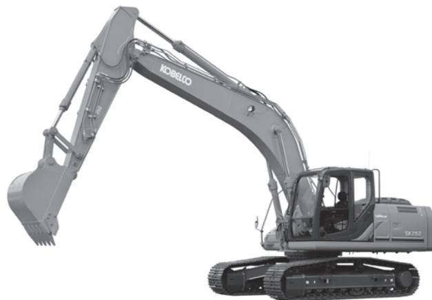
写真 2 コベルコ建機 SK250-9 油圧ショベル
