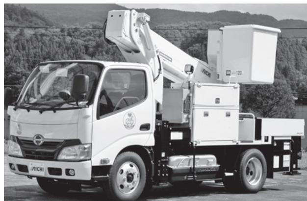
写真一 4 アイチコーポレーション SH11A-P280 HV トラック架装高所作業車
