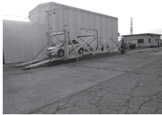
写真一9 シンザーズ展開と同時に床版も展開され、その後車両走行
