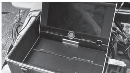
写真一 4 地上で操縦者が利用するモニタ
