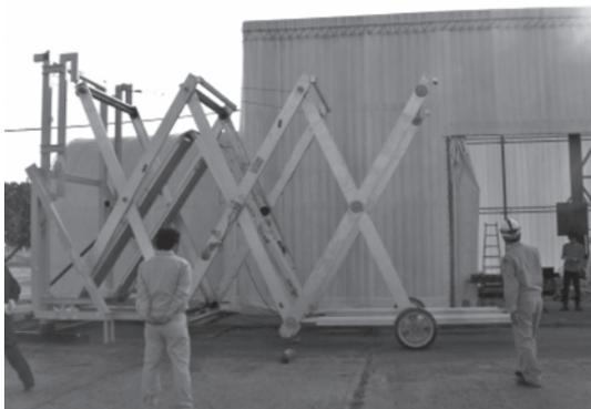
写真一7 公開直前の手動ウィンチによる展開確認実験
