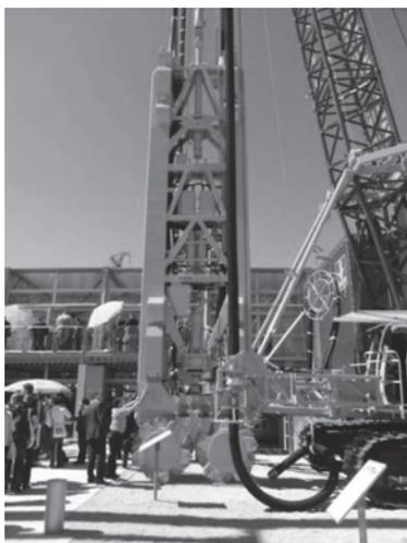
写真-19 水平多軸回転カッター BC35
