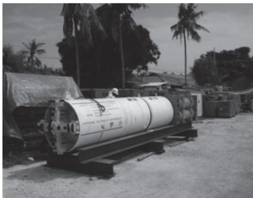
写真-11 泥濃式推進機
