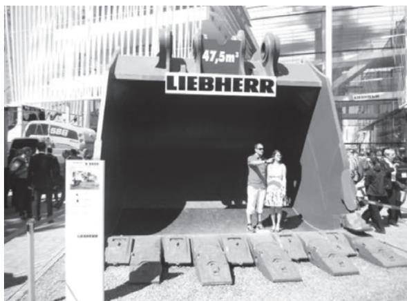
写真—12 鉱山用油圧ショベル R9800 の 47.5 m<sup>3</sup> バケット
