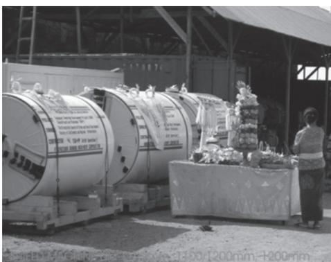
写真-7 泥水加圧式推進機
