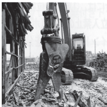
写真一 鉄骨切断機 (日立建機(株)建設業労働災害防止協会提供)
