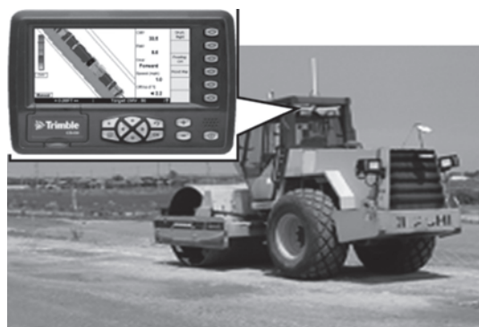
図一3 TS・GNSS による締固め管理技術
