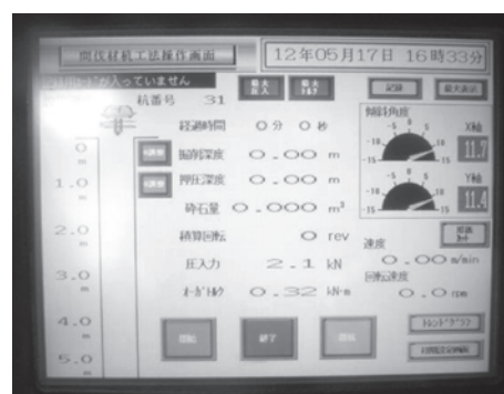
写真—3 木杭 操作画面
