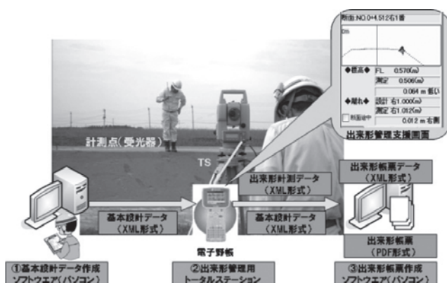
図—1 TS による出来形管理技術（土工）
