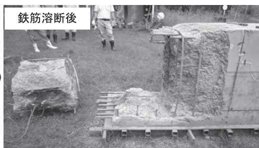
写真－2 「本工法」による鉄筋コンクリート部材の切断状況
