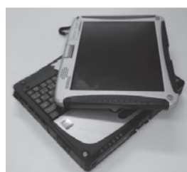
写真—11 左:防塵・防滴・耐衝撃型 PC（パソコン）、右:画面表示例（ジャッキ推力、支点反力）
