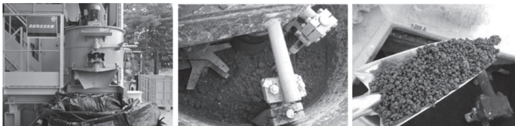
写真—4 濃縮残渣(脱水ケーキ)の粒状化
