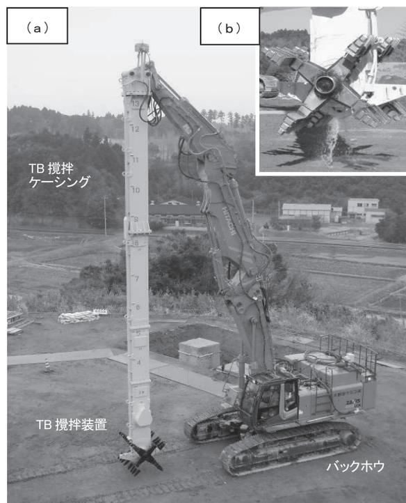
写真—1 本工法施工機全景
