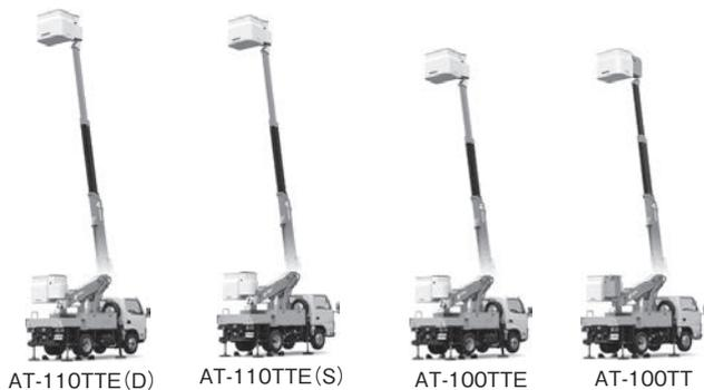
写真—3 タダノ 通信工専用高所作業車
