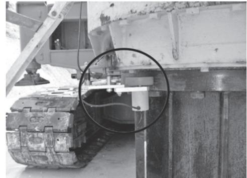
写真-2 回転計の設置状況
