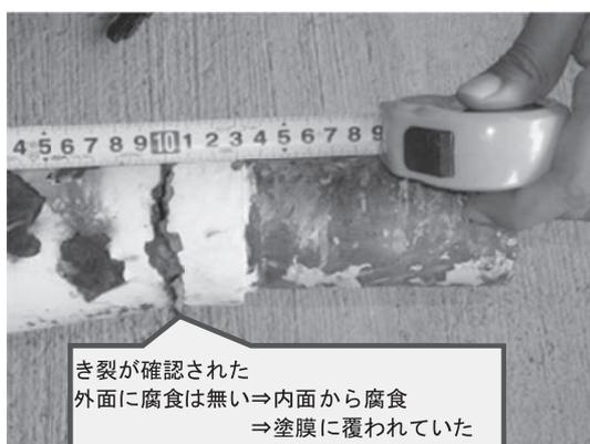
図一四 支柱先端の灯具取付け部のき裂
