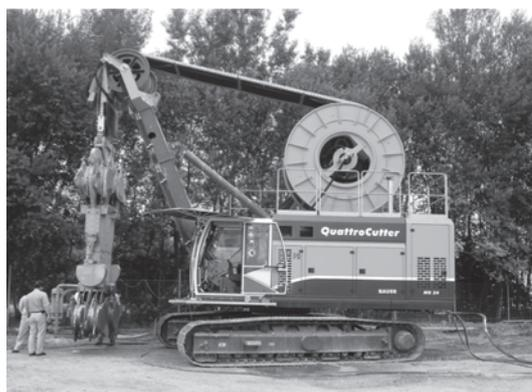
写真一 2 BCM5 型 本施工機 (クアトロカッター)
