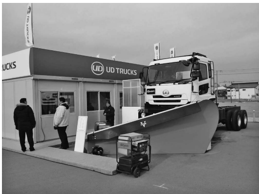
写真—10 除雪専用車 CZ（ATM）（UDトラックス）
