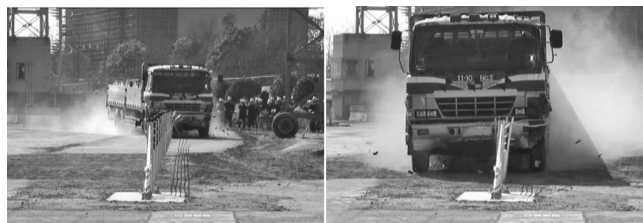
写真―6 防護柵衝突後の大型貨物車の軌跡
