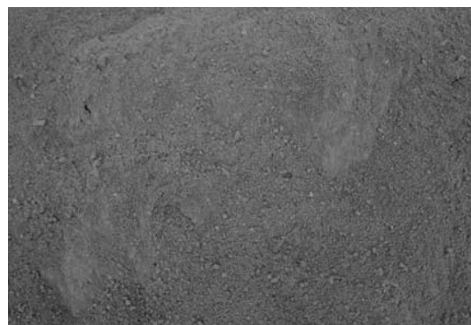
写真—4 粉碎された不燃混合物
