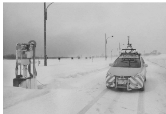
写真—4 視程計の比較計測状況
