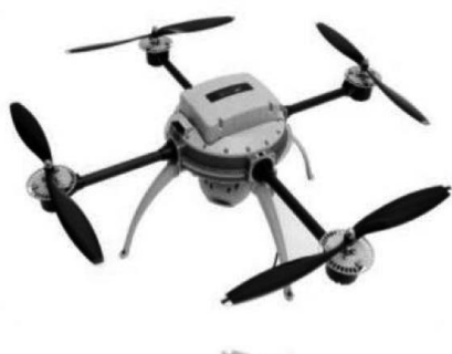
写真—3 自立航法型無人探査機（UAV）
