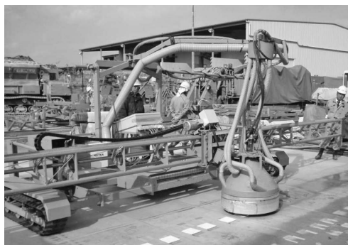
写真—4 試作機（スプレーヤー）試験状況
