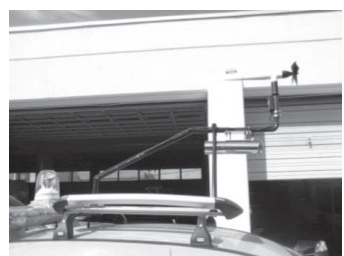
d) 風向風速計と温度計の取付状況 (写真右側が車両前方)
