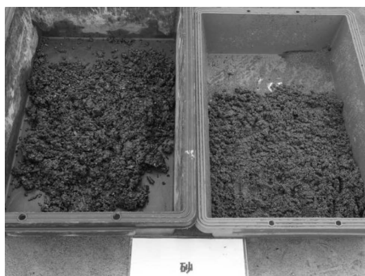
写真—6 分級された礫や砂 (左：2段目スクリーンの礫、右：1段目スクリーンの砂)
