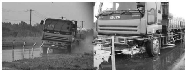
写真—3 実車衝突実験の状況（板厚 4.2 mm）
