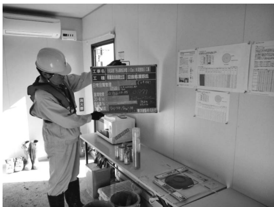
写真—4 筒先での処理土の消泡率、およびフロー値の確認
