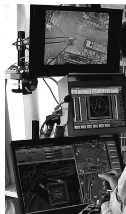
写真2 運転室のモニター。上から順に・ジブ先端カメラ用モニター、 ・クレーン計器モニター、・運転室PCモニター
