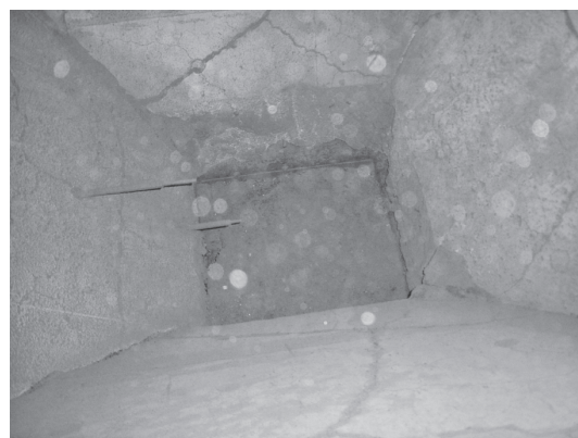
写真—6 エアパージ装置取付後の炭化物排出状況
