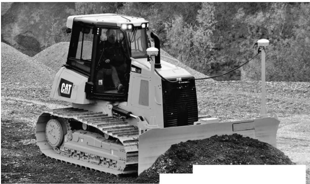
写真―2 キャタピラージャパン Cat D6K 2 ブルドーザ
