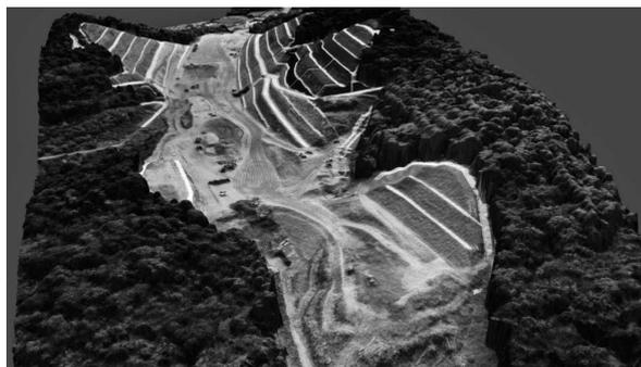
図一 16 3D モデルの Acrobat 出力例 (高速道路工事)<sup>3)</sup>
