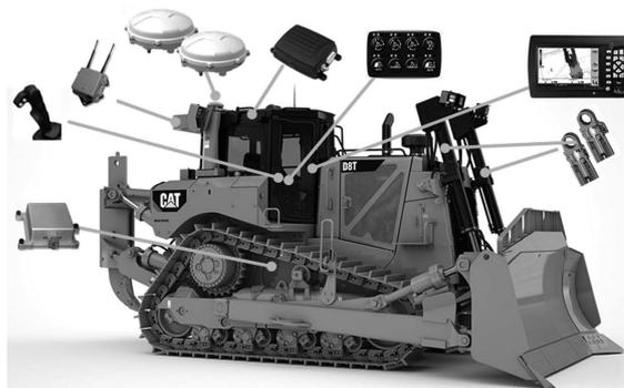
図-4 海外仕様のグレードコントロール仕様ブルドーザ
