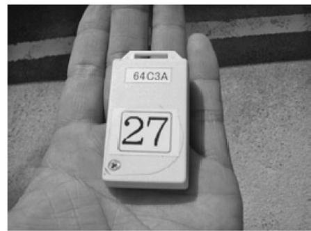
写真-2 セミアクティブ型 IC タグ
