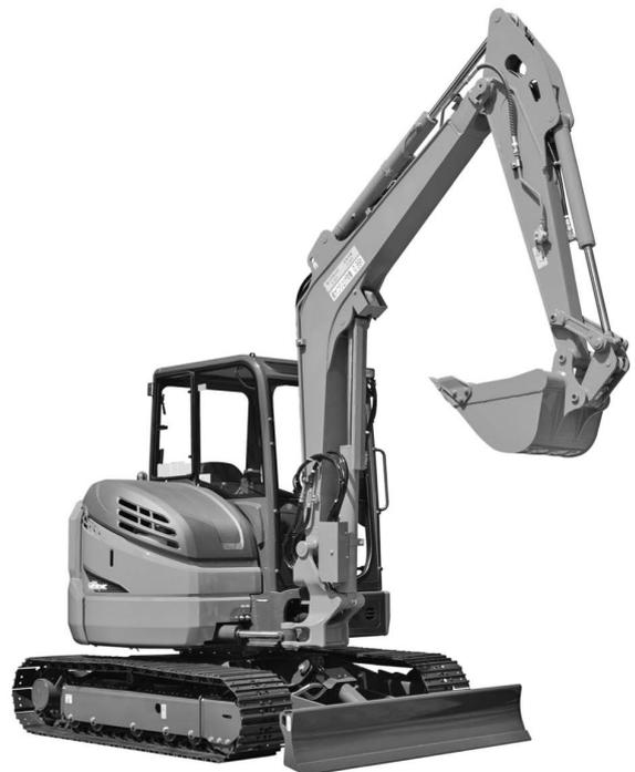
写真一3 コベルコ建機 SK55SR-6 ミニショベル (後方超小旋回型)
