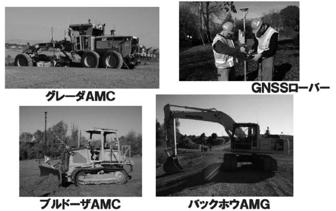
図二 情報化施工の例 (建設機械と測量における ICT の活用)
