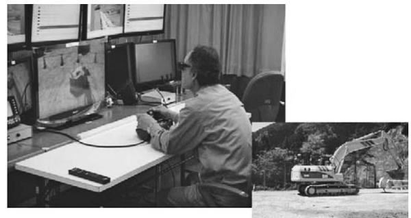
写真一七 標準画像とハイビジョン画像の比較実験風景
