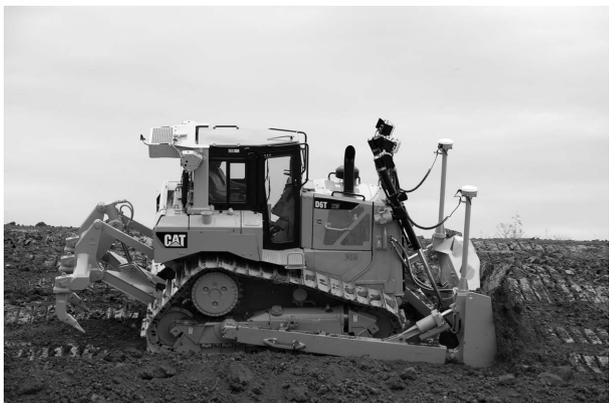
写真-1 アクユグレード搭載ブルドーザ
