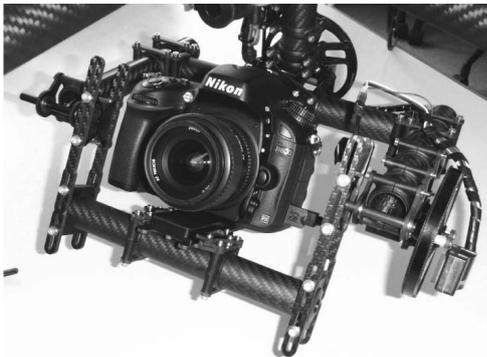
写真-3 搭載カメラと2軸ジンバル
