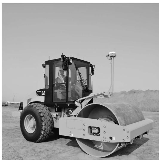
写真-3 海外のGNSS対応の振動ローラ
