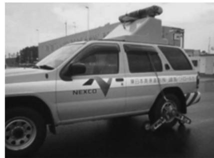
(a) 路面の凹凸プロファイルの計測装置
