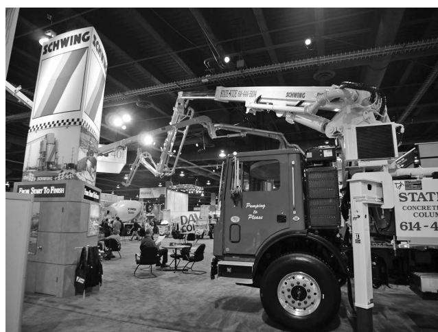
写真—7 シュヴィング ブーム付きコンクリートポンプ車
