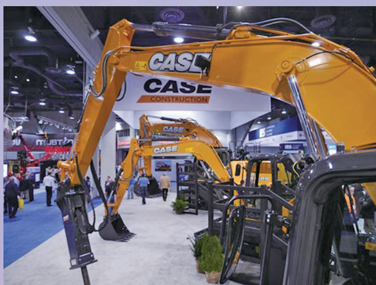
油圧ショベル CX160D + プレーカアタッチメント
