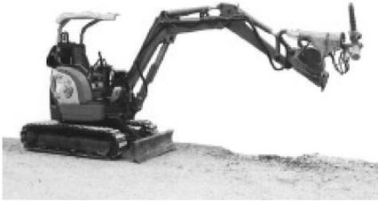
写真—14 油圧ショベルに専用アタッチメント付
