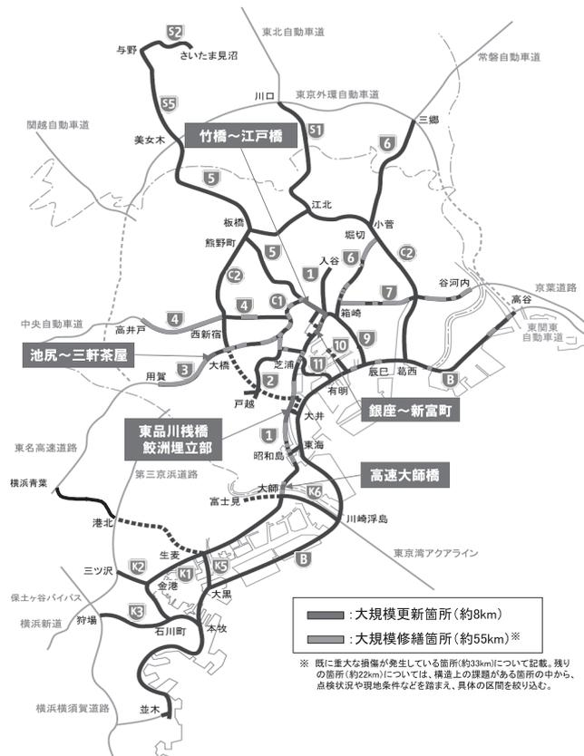
図-4 大規模更新、大規模修繕の実施箇所
