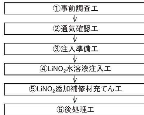
図-2 本補修工法の施工フロー
