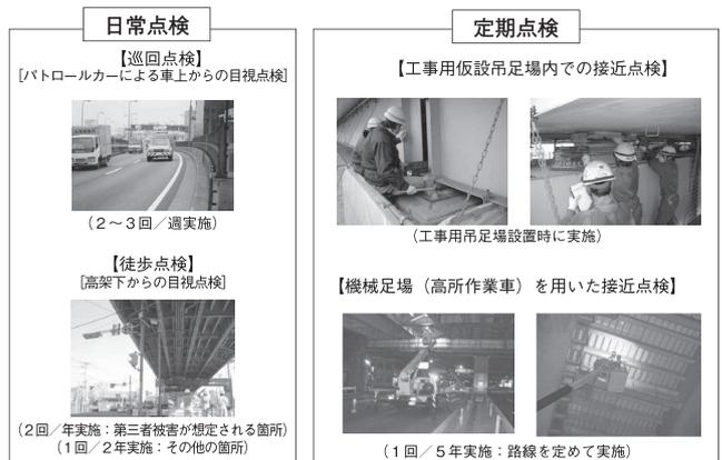
図-2 構造物の点検事例
