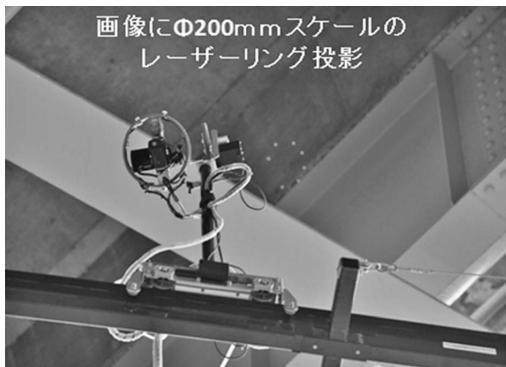
写真—17 レーザーポインター照射装置
