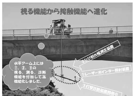
写真—20 各種測定機器搭載の可能性
