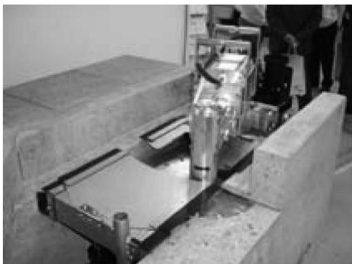
写真-2 本工法カッター装置の概観
