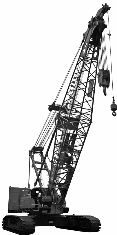
写真—6 IHI 建機 CCH1200-6 クローラクレーン
