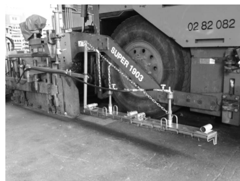
写真3 アスファルトフィニッシャーへの装着状況
