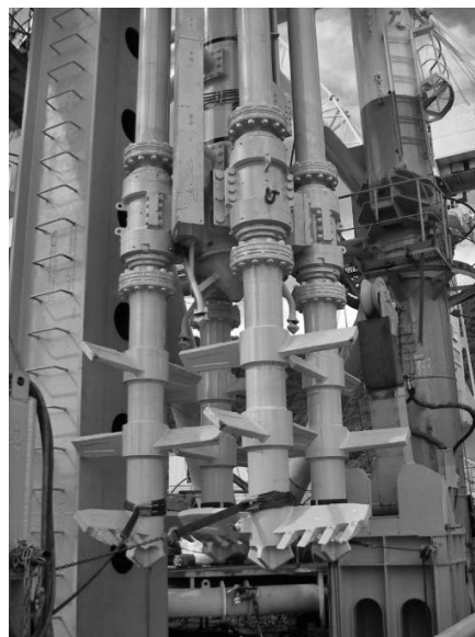
写真—3 処理機先端掘削部
