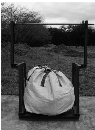
写真-2 固形対象物：土嚢 (800 mm \times 800 mm \times 高さ 800 mm, 質量約 300 kg)
