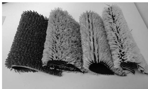
写真—3 袋材表面を人工芝構造として耐久性を高めたサンドバック
