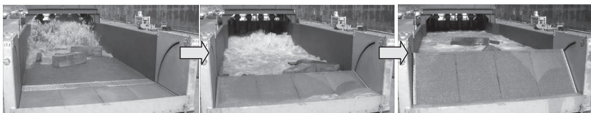
写真—3 流水（濁流）作動確認状況
