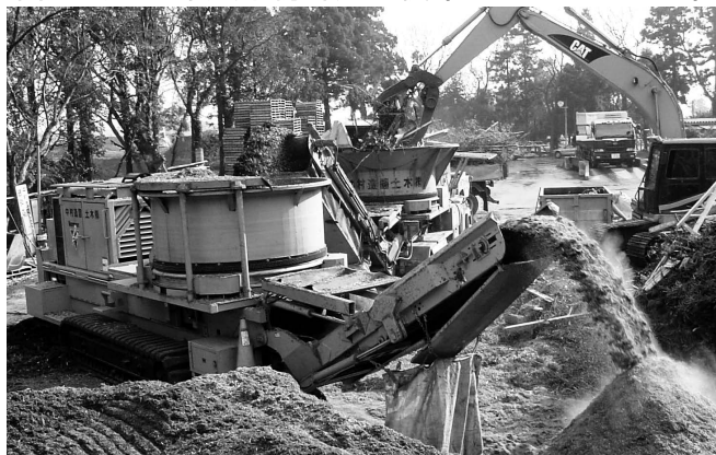
自走式大型木質系粉碎処理機（タブグラインダー）
