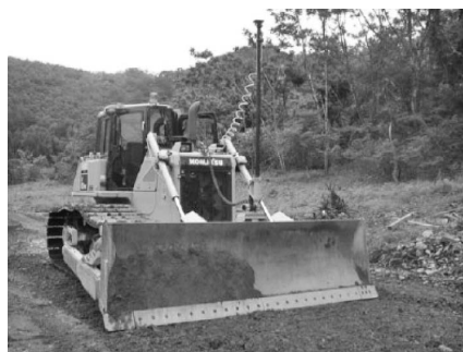
写真一 2 情報化施工機器の設置状況 (MC ブルドーザ)
