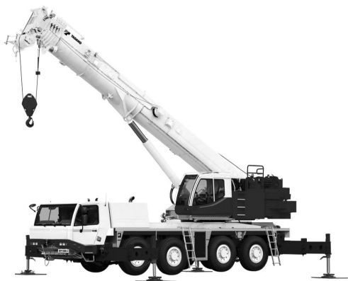
写真一6 タダノ ATF100G-4 オールテレーンクレーン
