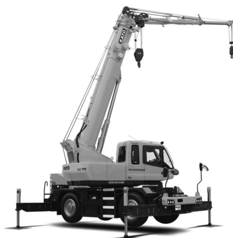
写真－5 加藤製作所 MR-200Ri PREMIUM ラフテレーンクレーン（伸縮ブーム形）
