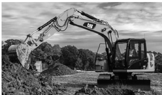
写真一2 キャタピラージャパン Cat 311FL RR 汎用小旋回型油圧ショベル
