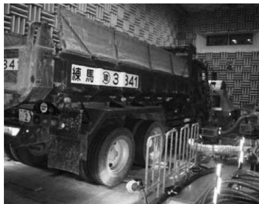
写真一 4 D13 モード運転試験写真
