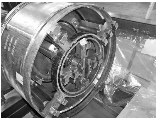
写真二 二重回転カッター面板
