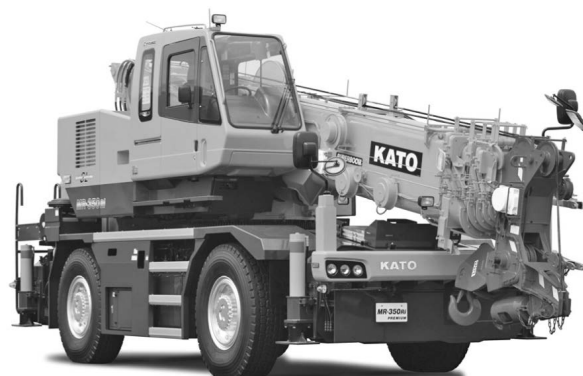
写真-1 加藤製作所 MR-350Ri PREMIUM ラフテレーンクレーン (伸縮ブーム形)
