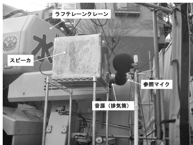
写真—1 「アクティブ消音システム」の適用状況
