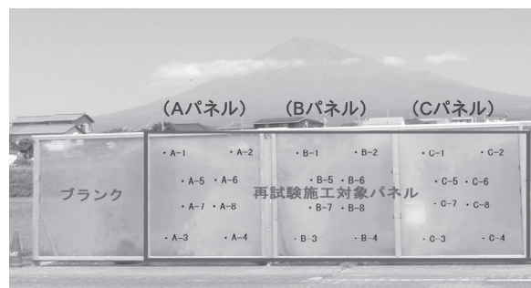
写真—5 実験対象の透光性遮音壁（記号は、パネル箇所と測定位置）
