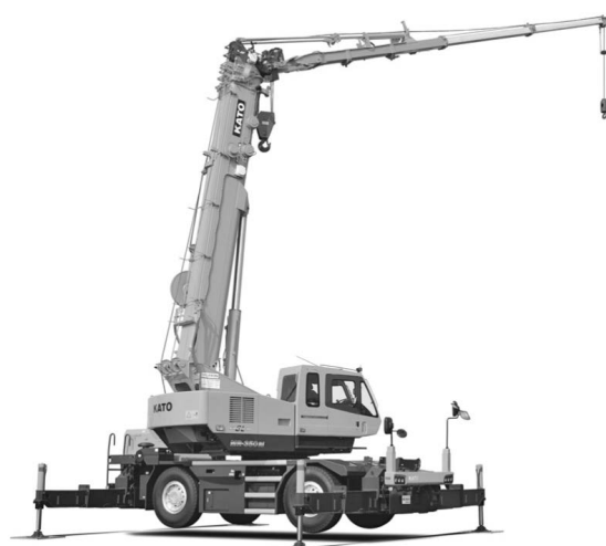
写真-2 加藤製作所 MR-350Ri PREMIUM ラフテレーンクレーン (伸縮ブーム形)
