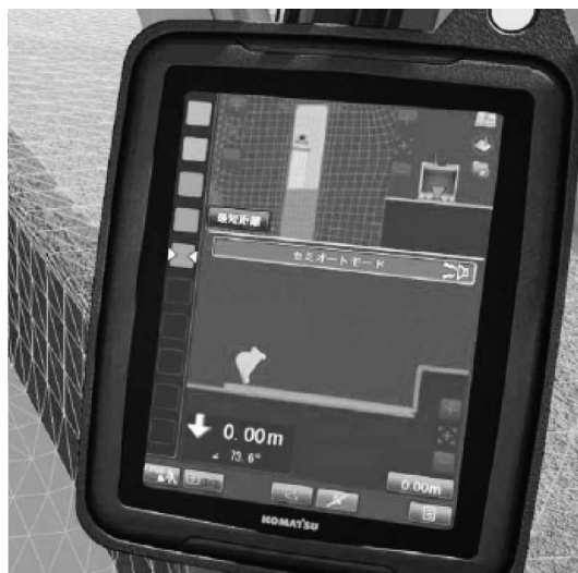
図—1 コントロールボックス
