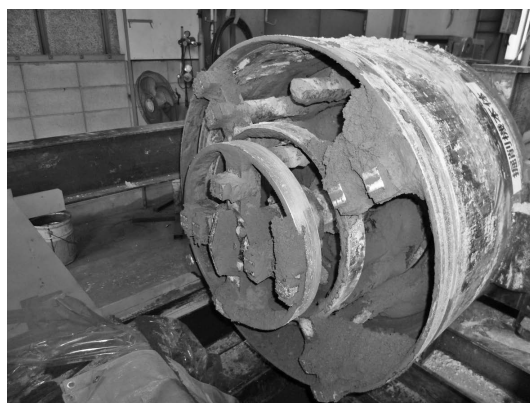
写真一 8 内カッター前出し 100 mm
