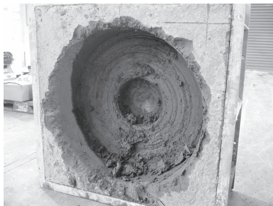
写真—9 掘進後の供試体 (前出し 100 mm)
