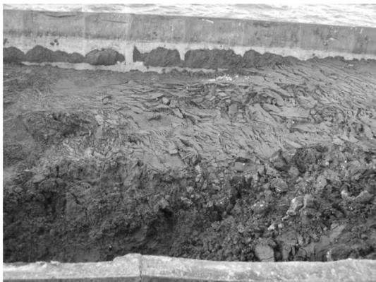
写真—6 処理前の浚渫土砂（細粒分約 60%）
