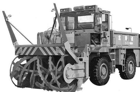
写真 2-61 東洋運搬機<sup>(注1)</sup> R350-2 平成2～4年
