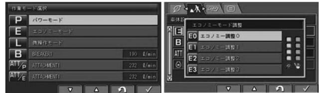
図一11 作業モード選択画面, Eモード調整画面
