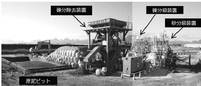
写真二 システム全景（60～80 m<sup>3</sup>/時間級ユニット）
