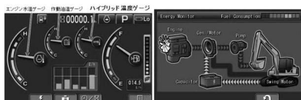
図-9 ハイブリッド温度ゲージ， エネルギーモニタ
