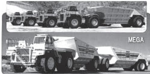
写真-44 トレーラ式ボトムダンプ
