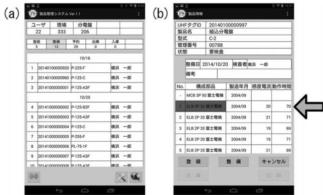
図-5 タブレットの画面を示した図。(a) 整備が行われた製品を一覧表示している。この画面では、タブレットから入力が行われた製品の実績を状態別に確認することができる。(b) 分電盤の検査データを入力する画面。矢印で示す行は、部品名の欄が赤く塗られている。この部品が品質基準を満たさず、交換の必要があることを警告している。
