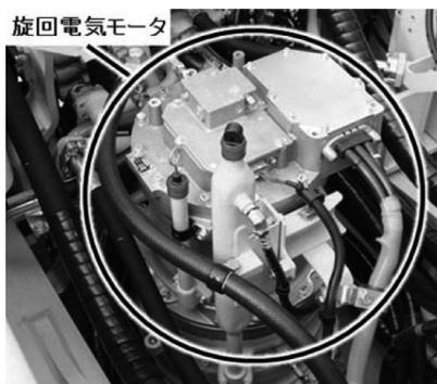
写真—2 旋回電気モータ
