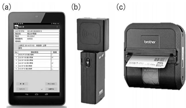
図-1 製品管理システムで使用する携帯端末。左から (a) タブレット (Google 社製 Nexus7), (b) ハンディ型タグリーダー (D.O.TEL 社製 DOTR-910J), (c) ラベルプリンター (ブラザー社製 RJ-4030) である。タブレットで動作する製品管理システムのプログラムが、他の 2 つのデバイスと Bluetooth で通信し制御する。
