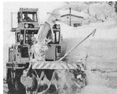
写真 2-117 高所運転室付ロータリ除雪車 (株新潟鐵工所<sup>(注3)</sup>) (北陸地方建設局と共同開発) 昭和 59 年
