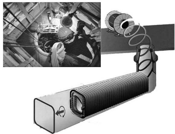
図-5 製管工法の一例
