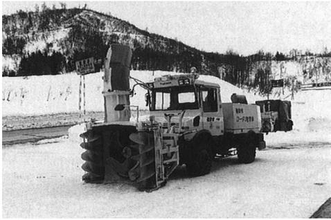
写真 2-107 立軸オーガ形、ツーステージ 450PS シュミット社 (西ドイツ) TS-4 昭和 62 年<sup>2)</sup>
