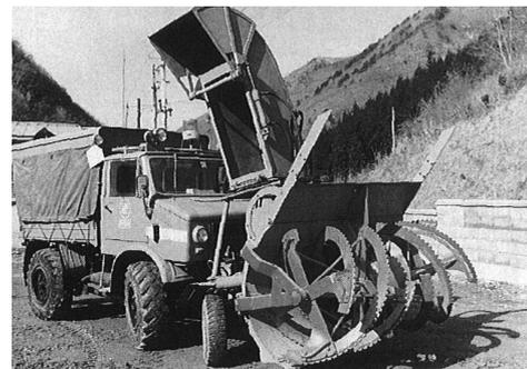
写真 2-106 リボンスクリュー、ツーステージ川崎ロールバ、KRH800 ロールバ社 (スイス) 昭和 38 年<sup>2)</sup>
