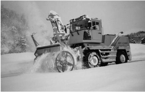
写真 2-111 ロータリ除雪車 NRS400 (4輪操舵) (株新潟鐵工所<sup>(注3)</sup>)
