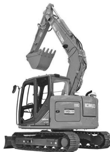
写真一 1 コベルコ建機 SK75SR-3E 油圧ショベル(後方超小旋回型)
