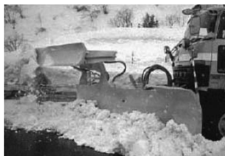
写真 3-65 中央分離帯処理プラウ 昭和 59 年
