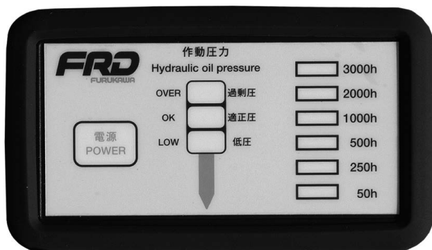
写真—12 「B-Pro」装置本体（光と音で稼働状況を知らせる）
