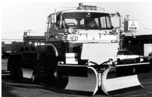
写真 3-57 高速道路用両端を折りたたみ狭小形大型アングリングプラウ 昭和 53 年
