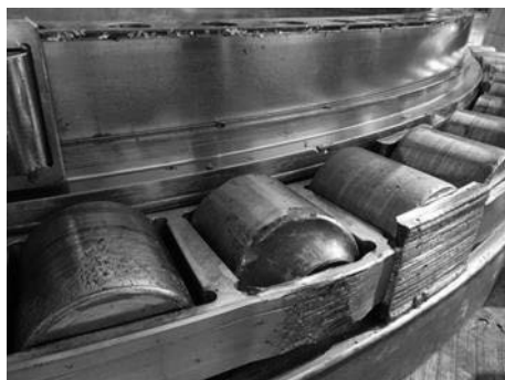
写真一八 TBM-2 メインベアリング損傷状況
