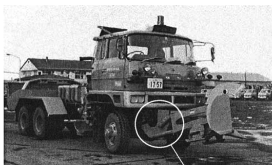
写真 3-44 10t車懸架装置 北海道開発局 昭和45年 1)
