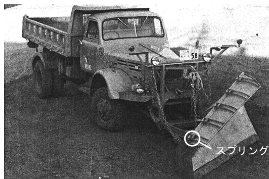
写真 3-28 スプリング付デフレクタ 北海道開発局 昭和34～40年 1)
