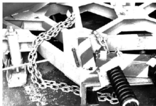
写真 3-46 チェーン式プラウ取付部の安全装置 昭和47年
