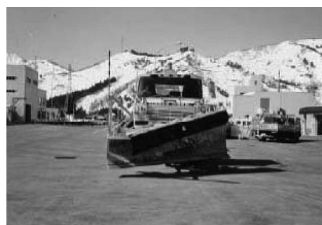
写真 3-66 中央分離帯処理装置（アタッチメント型、回送姿勢） 昭和 59 年
