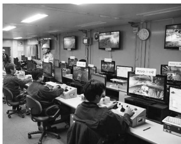
掘削管理室（無人化施工）
