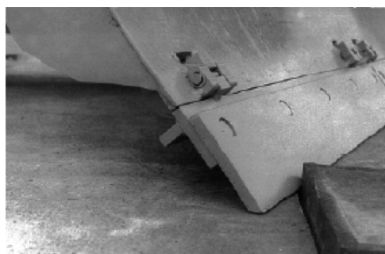
写真 3-52 シャーピン式安全装置 昭和 49 年
