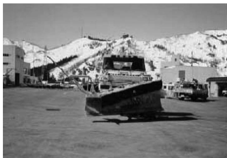
写真 3-67 中央分離帯処理装置（アタッチメント型，作業姿勢）昭和 59 年
