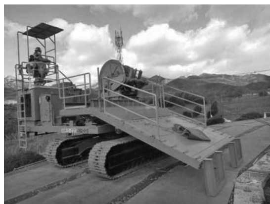
写真—1 「定張力油圧回路」を搭載したウインチポータ
