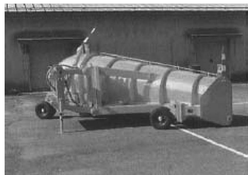
写真 3-60 左端部安全装置付きワンウェイプラウ (7t 用) 2)
