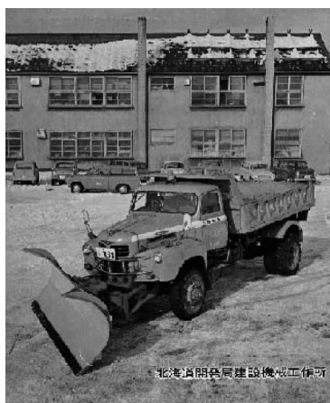
写真 3-37 切削角可変形アングリングプラウ 北海道開発局 昭和 42 年 5)
