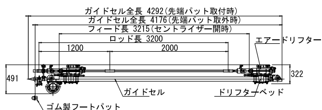
図—4 ライトロックドリルの構造
