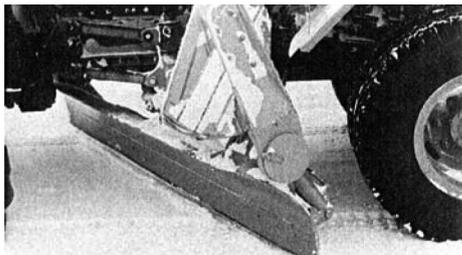
写真 3-94 シャッターを上げている状態 北海道開発局 昭和 52 年<sup>1)</sup>
