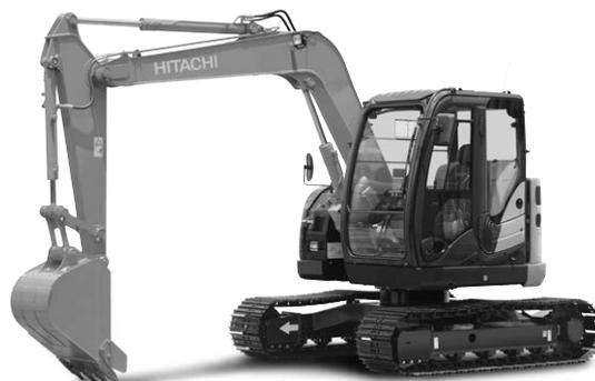
写真一3 日立建機 ZX75US-5B 油圧ショベル（後方超小旋回型）
