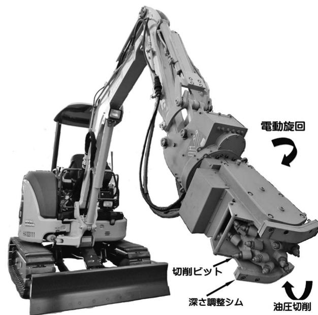
写真一 9 ウエルツ FTDU015 油圧ショベル用小型表面切削アタッチメント (フルコントルスディオ)
