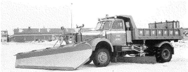
写真 3-89 平行リンク式、油圧アングリング式 北海道開発局 昭和 41 年
