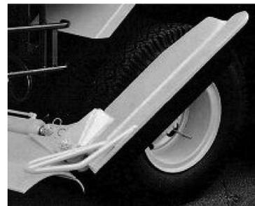
写真 3-92 ブレード左端折りたたみ・アングリング式トラックグレーダ
