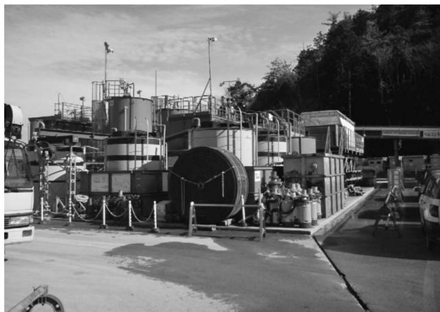
写真-5 濁水処理設備
