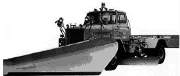
写真 3-90 平行リンク式、排雪方向固定式 協和機械製作所 昭和 43 年
