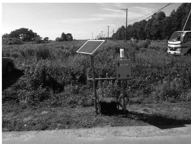
写真一3 電源供給装置
