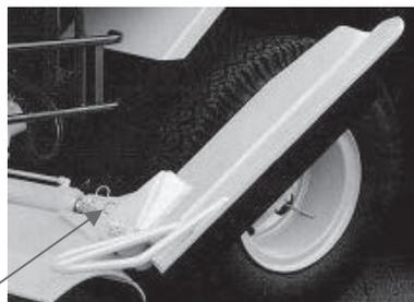
写真 3-96 ブレード折りたたみ部シャープピン式安全装置 昭和 53 年
