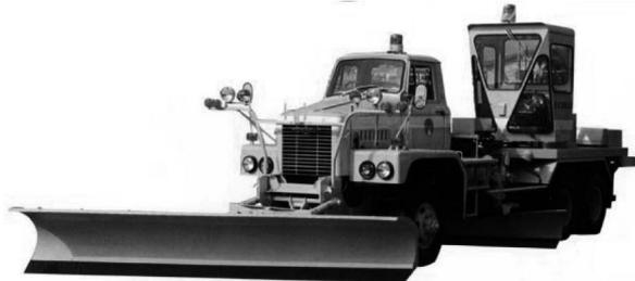
写真 3-91 高速道路用大型ブレードアングリング式トラックグレーダ
