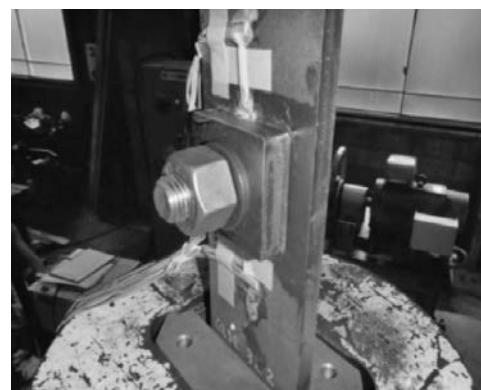
図一7 スタッドボルト溶接鋼板の引張疲労試験
