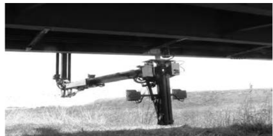
写真二 アーム先端の遠隔操作雲台付カメラ
