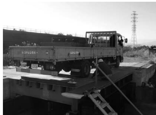
写真一2 実トラック荷重試験の状況
