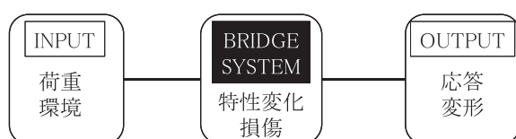
図-1 橋梁を対象としたセンシングシステムのコンセプト
