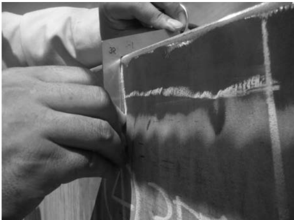
写真-3 部材角部形状
