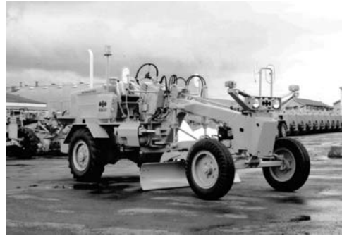
写真 4-33 2.2 m 級 65PS GD22AC-1A (株)小松製作所 昭和 52 年
