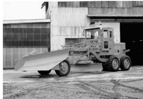
写真 4-23 3.0m級 110PS GD30-5M (株)小松製作所 昭和 42 年
