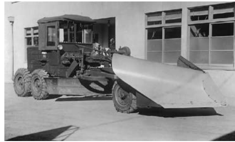
写真 4-3 3.1 m 級 65PS MGII 幌製キャブ スノーブラウ付き 東日本重工業(株) (注4) 昭和 25 年
