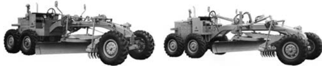
写真 4-20 共に 3.7m 級 125PS, LG2-M 機械式(左)と LG2-H 油圧式(右) 三菱重工業(株) 昭和 41 年
