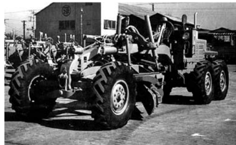
写真 4-17 3.7 m 級 定格 102PS, 最大出力 115PS LGⅡ-H 三菱日本重工業(株) (注4) 昭和 35 年 2)
