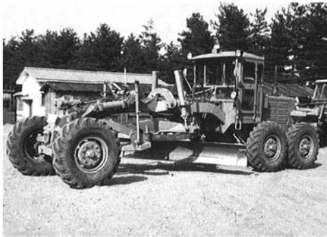
写真 4-19 3.7m級 定格出力 102 PS, 最大出力 115PS LG2-H 三菱重工業(株) 昭和 39 年 2)
