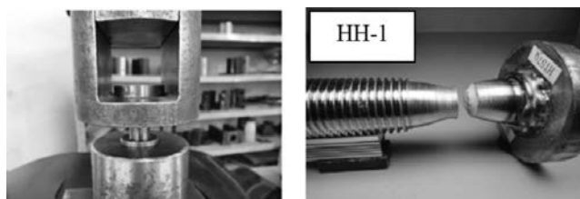
図一6 スタッドボルトの引張試験
