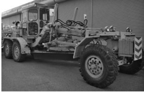
写真 4-31 4.0 m 級 165PS GD40-HT-2A (株)小松製作所 昭和 49 年
