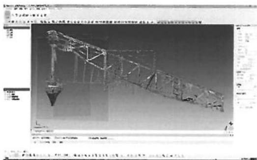
図—6 3次元実測結果より作図した鉄骨詳細図
