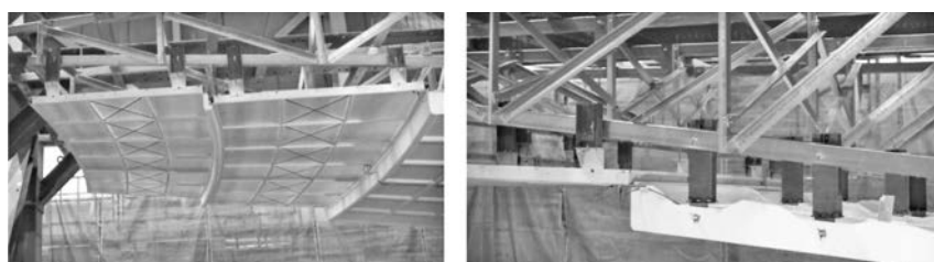
写真—6 芳賀波加振後の試験体（左右とも）
