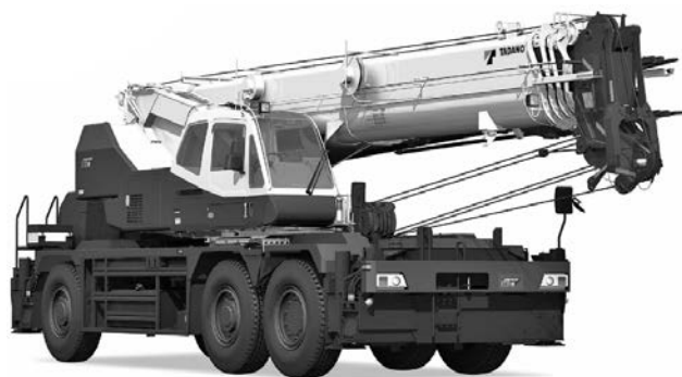
写真—6 タダノ CREVO 500G3α, GR-500N ラフテレーンクレーン
