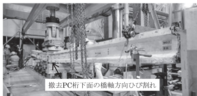
写真一6 撤去 PC 桁の曲げ試験
