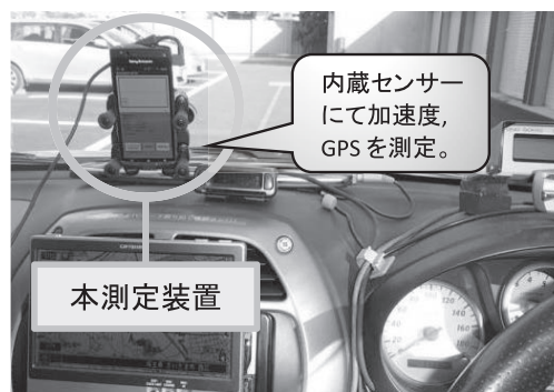
写真—1 本測定装置設置例
