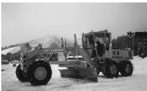
写真 4-55 4.3 m 級 320PS 高速圧雪整正機 SR320 (ブレード自動制御付) 三菱重工業(株) 平成 2 年
