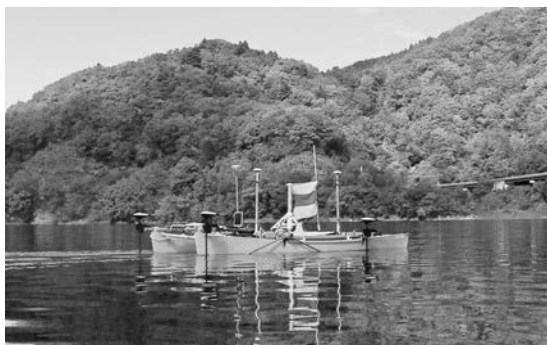
写真一 自動航行測量状況
