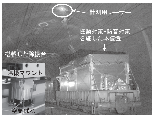
写真—8 対策した試作機における新幹線トンネル内における試験状況
