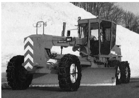
写真 4-54 4.3 m 級 320 PS 高速圧雪整正機 GH320-2 (ブレード自動制御付) (株)小松製作所 平成元年 2)
