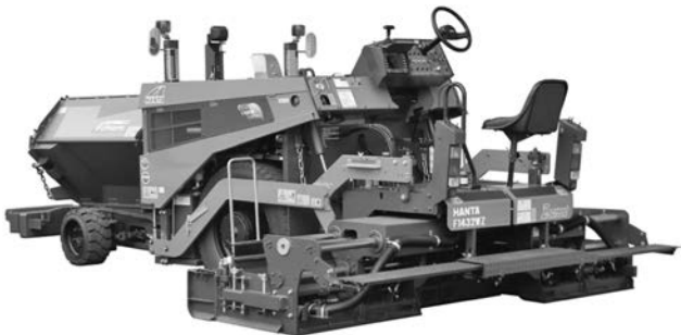
写真— 10 範多機械 F1432W5 アスファルトフィニッシャ
