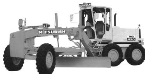
写真 4-52 3.7 m 級 157PS MG430 三菱重工業(株) 平成元年
