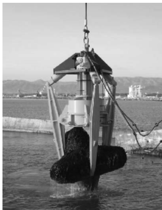
写真—4 大裕 F3C 消波ブロック吊上装置
