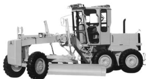
写真 4-61 3.1 m 級 115PS MG230 (E) 三菱重工業(株) 平成 9 年
