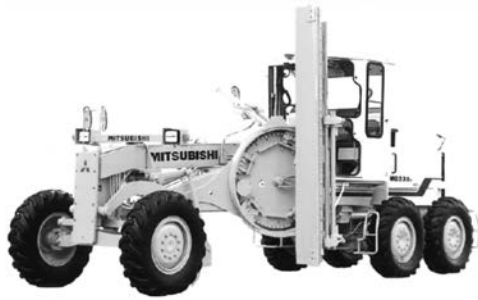
写真 4-62 3.4 m 級 137PS MG330 (E) 三菱重工業(株) 平成 9 年
