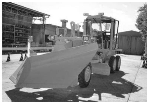
写真 4-60 2.8 m 級 95PS MG130 (E) 三菱重工業(株) 平成 9 年
