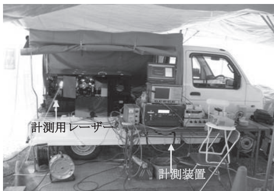
写真—5 コンクリート剥離検査装置の試作機
