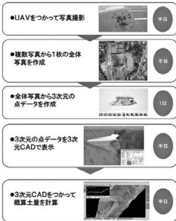
図一5 3DCAD 対応までの流れ
