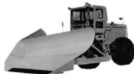
写真5-11 プラウ付ホイールドーザ180Ⅲ 東洋運搬機(株)<sup>(注1)</sup> 昭和43年
