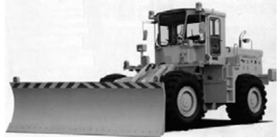
写真 5-29 18t級除雪専用ドーザ 180S II 東洋運搬機株式会社<sup>(注1)</sup> 昭和62年
