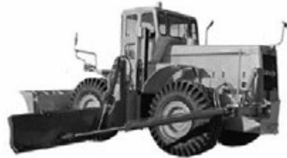
写真 5-21 Uブレード付き除雪ドーザ KLD70
