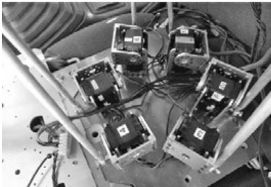
写真一1 胴体部のリンク機構
