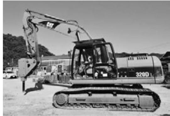
写真-13 破碎作業用のバックホウ
