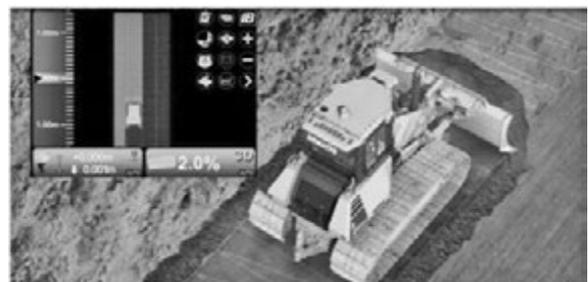
図—2 ICT ブルドーザー 3次元施工データ
