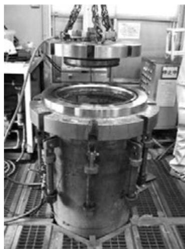
写真一 5 耐圧試験状況 (30 MPa)
