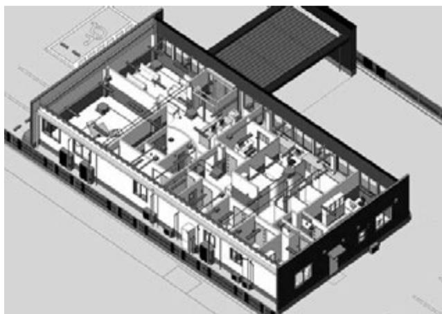
図-1 BIMモデルの例。内部には隠れた柱や梁、配管なども忠実に作られている（資料提供：美保テクノス）
