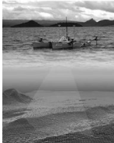
写真三 堆積物の調査ロボット
