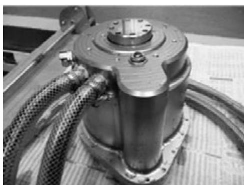
写真一 4 駆動装置 (マニピュレータ部)
