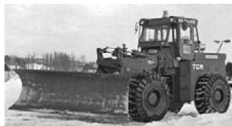
写真 5-15 12t級除雪ドーザ 75ⅢA 東洋運搬機<sup>(注1)</sup> 昭和45年
