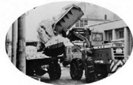
写真 5-5 ホイールローダ 85A 東洋運搬機(株)<sup>(注1)</sup> 昭和35年<sup>3)</sup>
