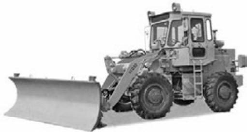
写真 5-23 6t 級除雪ドーザ STD30 東洋運搬機株<sup>(注1)</sup> 昭和 51 年
