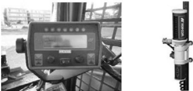
写真一5 制御装置とレーザ受光器
