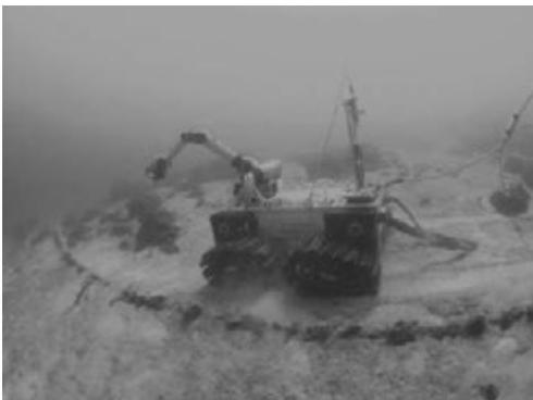
写真—9 海底でのケーブル調査状況
