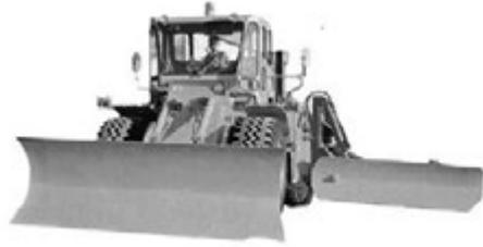
写真 5-20 全油圧サイドウイング 東洋運搬機株<sup>(注1)</sup> 昭和49年
