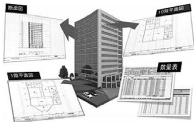
図-2 BIMモデルをいろいろな視点で切断することで図面が作れる（資料提供：福井コンピュータアーキテクト）
