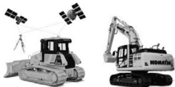
写真一五 ICT 建機 D61PXi と PC200i
