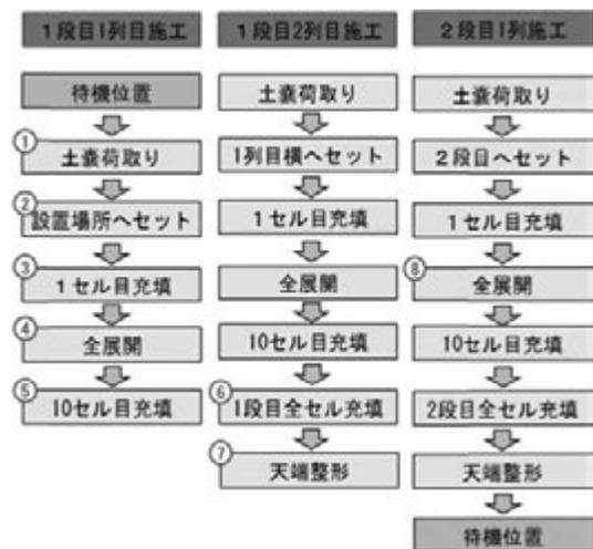
図-3 新型土嚢施工フロー
