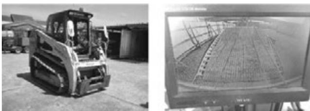
写真一6 安全補機類 (バックミラーとバックモニター)
