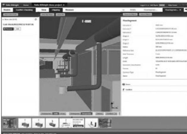
図一四 構造部材と配管の干渉チェックの例（画像提供：テクラ）
