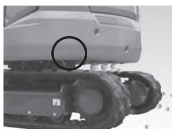
写真—9(d) 下方排風システムあり
