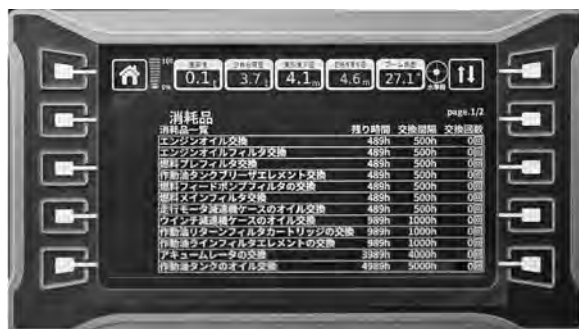
写真一10 モニタ (消耗品表示)
