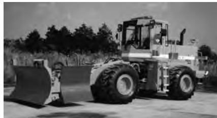
写真 5-39 E180 用折りたたみ式サイドスライディングブラウ 東洋運搬機(株) (注1) 平成 9 年
