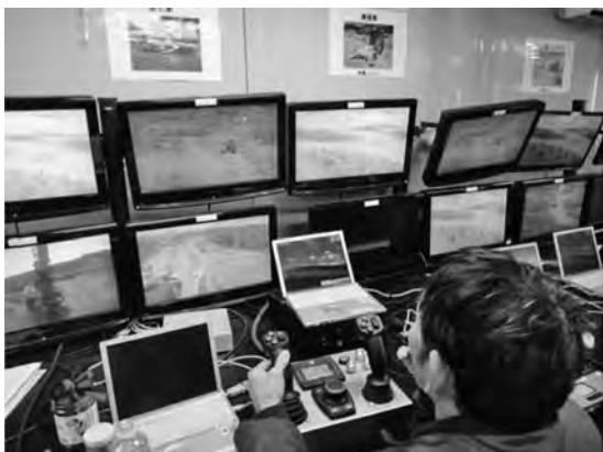
写真—4 無人化施工操作室
