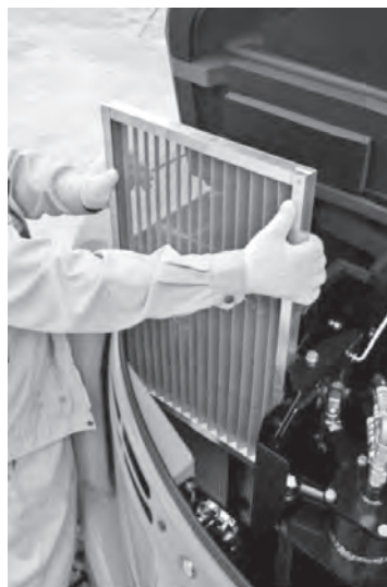
写真ー7 新防塵フィルターの脱着
