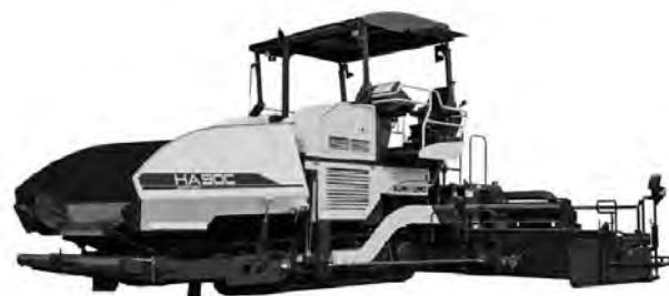
写真—5 住友建機 HA90C-2 アスファルトフィニッシャー
