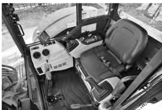
写真—3 キャブ仕様運転室内
