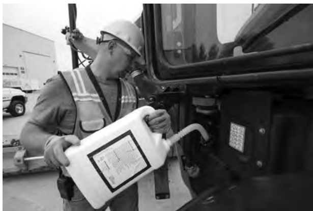
写真一六 地上からの尿素水補給
