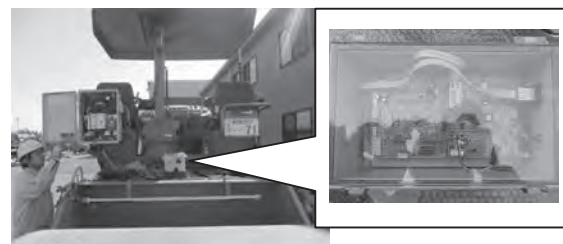
写真—8 慣性センサ機器構成
