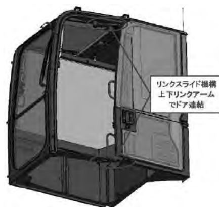
図一4 キャビン リンクスライド機構
