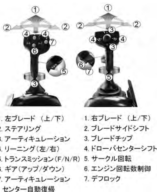
図二 ジョイスティックの操作方法
