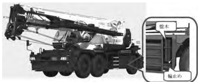
図一7 盤木と輪止めの格納位置(右側面も同様)
