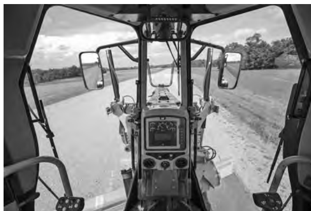
写真-5 オペレータステーション
