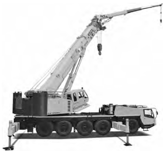
写真—3 加藤製作所 KA-1300R オールテレーンクレーン (伸縮ブーム形) (作業時)
