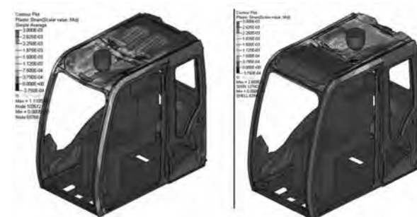
図一 7 FOPS 試験の弾塑性解析
